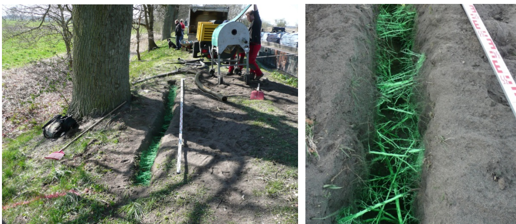
Bild 23: Eichenwurzeln (grün eingefärbt) im Damm der Stör-Wasserstraße. (Quelle: BfG).
