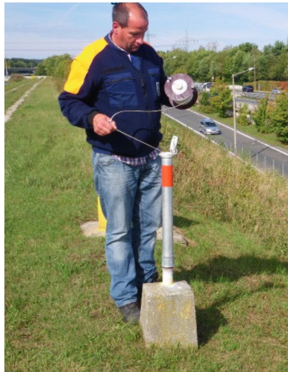
Bild 56: Grundwasserstelle - Messung mit dem Lichtlot (rechts Quelle: WSA Nürnberg)
