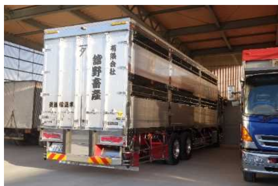
（右）3 台の出荷用トラック。中央がオールステンレスの 10 t 車（1 回 120 頭搬送可能）
