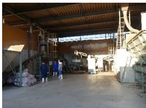
(右) 篩・造粒機((株)垣内)・ベルトコンベア、梱包などで構成するペレット堆肥製造ライン
