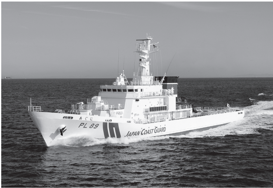
尖閣専従船の一隻、巡視船「あくに」。後部はヘリ甲板となっている。武装は20ミリ機銃1門と高圧放水砲を装備する(提供:海上保安庁)
