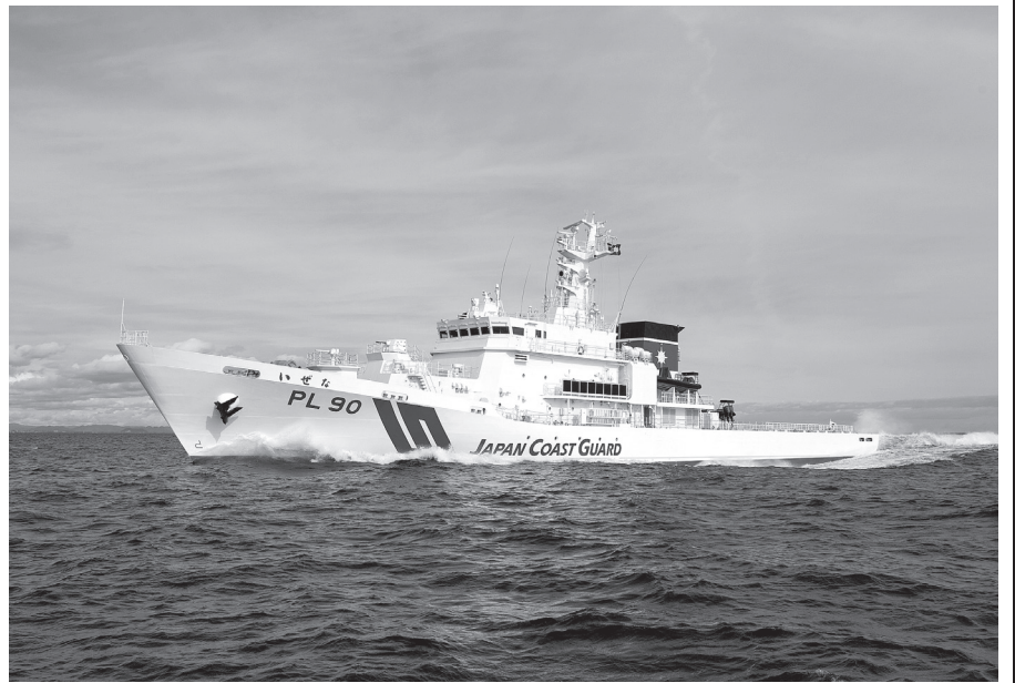
「あくに」と同型の巡視船「いぜん」。船橋横の黒い板は警告文を表示する電光掲示板である。10隻とも沖縄の島の名をつけている(提供:海上保安庁)
