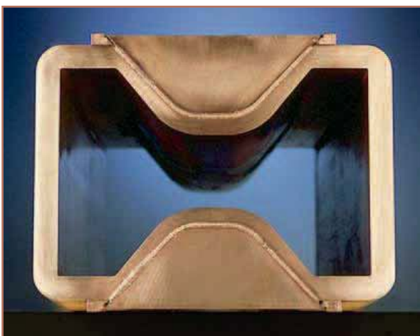
Abbildung 18: Mit dem Elektronenstrahl eingeschweißte Passtücke an Eingusskokillen aus CuCrZr für die Stahlindustrie (Einschweißtiefe: 40 mm) [56]
