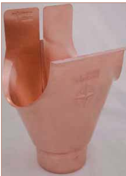
Abbildung 9: Mit dem Rollennahtschweißen gefertigter Meisterstützen zur Dachentwässerung aus 0,6 mm dickem Cu-DHP [64]
