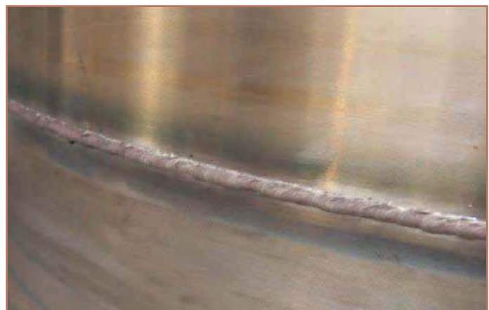
Abbildung 13: Elektronenstrahlgeschweißte Bronzebuchse aus CuSn12Pb mit 68 mm Einschweißtiefe [56]
