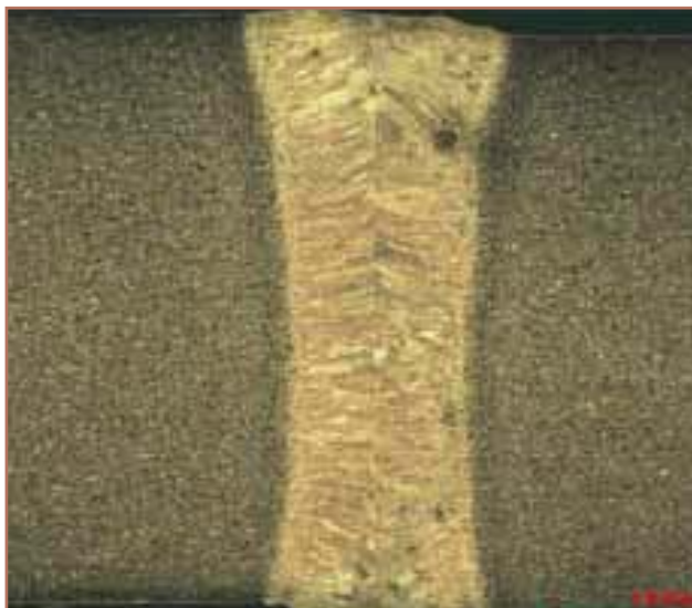
Abbildung 14: Laserstrahlgeschweißte Verbindung aus 4 mm dickem CuCn6, hart, mit 4 kW Faserlaser [41]
