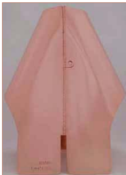
Abbildung 9: Mit dem Rollennahtschweißen gefertigter Meisterstützen zur Dachentwässerung aus 0,6 mm dickem Cu-DHP [64]
