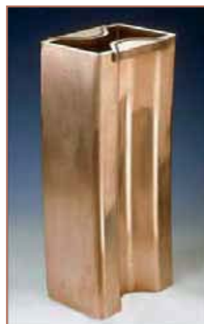
Abbildung 18: Mit dem Elektronenstrahl eingeschweißte Passtücke an Eingusskokillen aus CuCrZr für die Stahlindustrie (Einschweißtiefe: 40 mm) [56]
