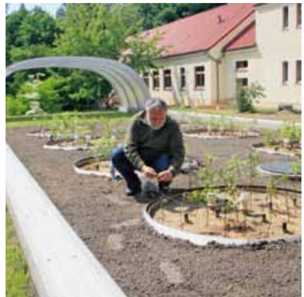
Abb. 5: Im „Drylab“ kann der Wuchs junger Bäume verschiedener Herkünfte im Freiland unter kontrollierten Feuchtigkeitsbedingungen untersucht werden. Bei Regen fährt das bewegliche Dach (im Hintergrund) automatisch über die Bestände. Die Wasserzufuhr erfolgt gezielt durch Bewässerung.
