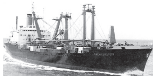
Die neuen Schnellfrachter von 1967 wie hier die SACHSENSTEIN konnten nur wenige Container an Deck befördern. (Hapag-Lloyd).
