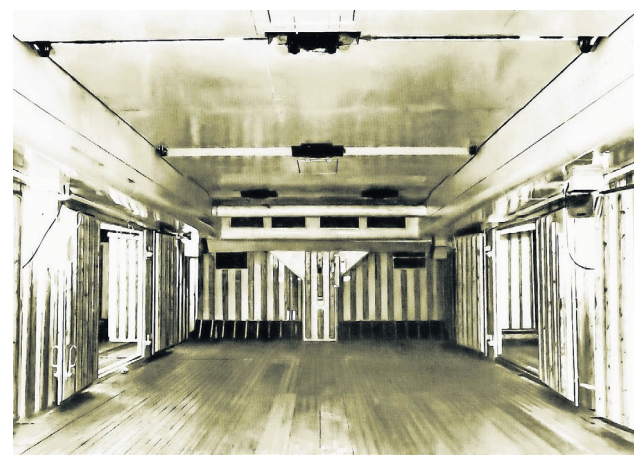
Zwischendeckskühlraum mit Aluminiumgräten in einem Kühlraum eines CAP-Schiffs.
