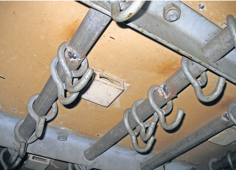
Deckenhaken auf einem Kühlfrachtschiff in den 60er Jahren.
