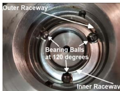
Fig. 10 Testarea frecării în rulmenții radial axiali cu 3 bile [15,16].
