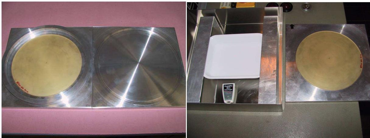
Abbildung 5-7: Gefäße zur Lagerung der aufgeladenen Prüflinge bei verschiedenen Umgebungstemperaturen (links) und relativen Luftfeuchten (rechts)
