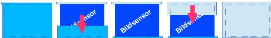
Abbildung 5: Prinzip des Schlitzverschlusses
