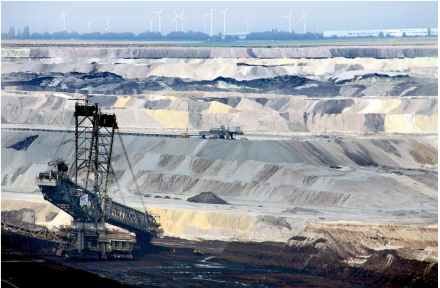
Auf dem rund 40 Quadratkilometer großen Tagebaugelände bauen gleich acht Schaufelradbagger Kohle und Erdreich ab
