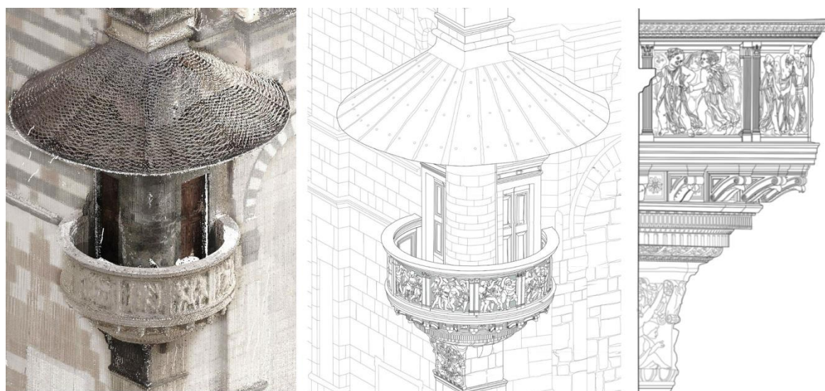
Figura 3. Il database delle nuvole di punti del laser scanner 3D e l'elaborazione del disegno 2D.
