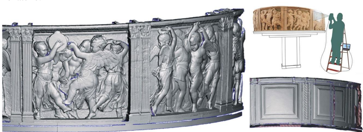
Figura 4. Acquisizione range-based del pulpito interno mediante Laser Artec Eva. A sinistra, dettaglio del modello 3D delle formelle III e IV.
