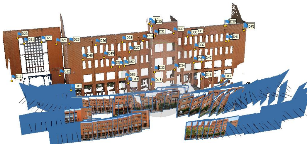
Figura 3. Vista general de las imágenes tomadas, con detalle de algunos puntos de apoyo.
