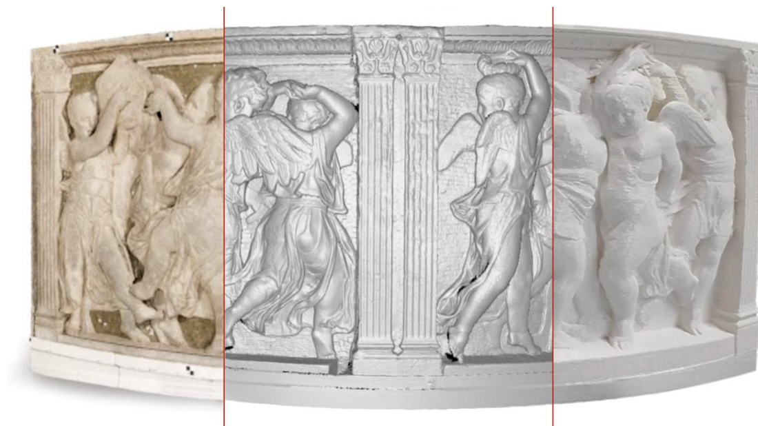
Figura 6. I duplicati digitali del pulpito originale di Donatello. A sinistra il modello fotogrammetrico, al centro il modello ottenuto da strumenti a scansione laser, a destra la stampa 3D.
