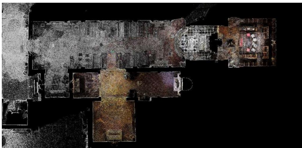
Figure 6. La pianta della chiesa in uno screenshot della nuvola di punti
