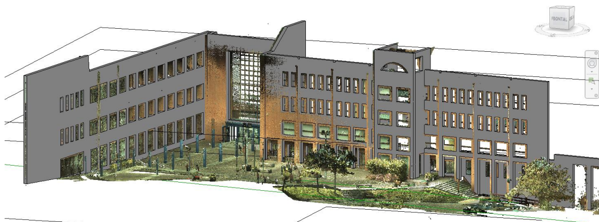
Figura 121 Vista global del modelo 3D con la nube de puntos integrada.
