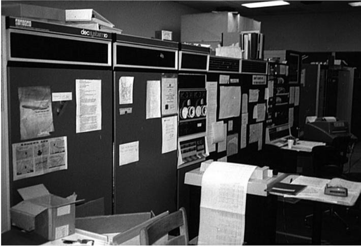
**Abbildung 7.1:** PDP-10-Rechenanlage mit Zentraleinheit KL-10 (ähnlich der im AI Lab), Stanford Artificial Intelligence Laboratory, 1979.
