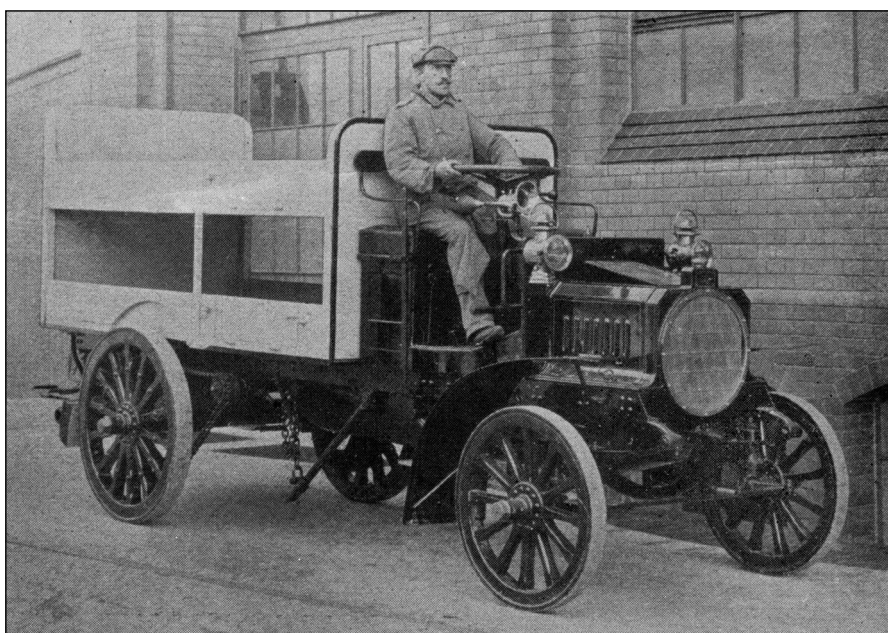
Milchwagen auf der DLG-Ausstellung 1905 (8-PS-Zweizylindermotor) 1
