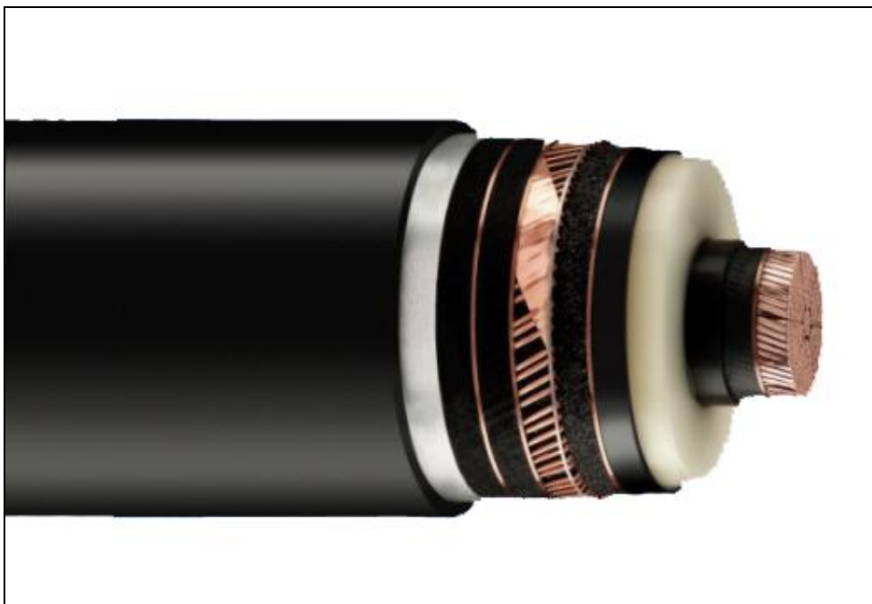
Bild 4.2. 380-kV-VPE-Einleiterkabel 2XS(FL)2Y 1×2500RM/50: 6-Segment-Millikenleiter, Kupferquerschnitt 2500 \text{ mm}^2 , PE-Mantel, Kupferschirm mit 50 \text{ mm}^2 Querschnitt, Aluminium-Dampfsperre, Außendurchmesser 14,2 cm (Quelle: Nexans)
