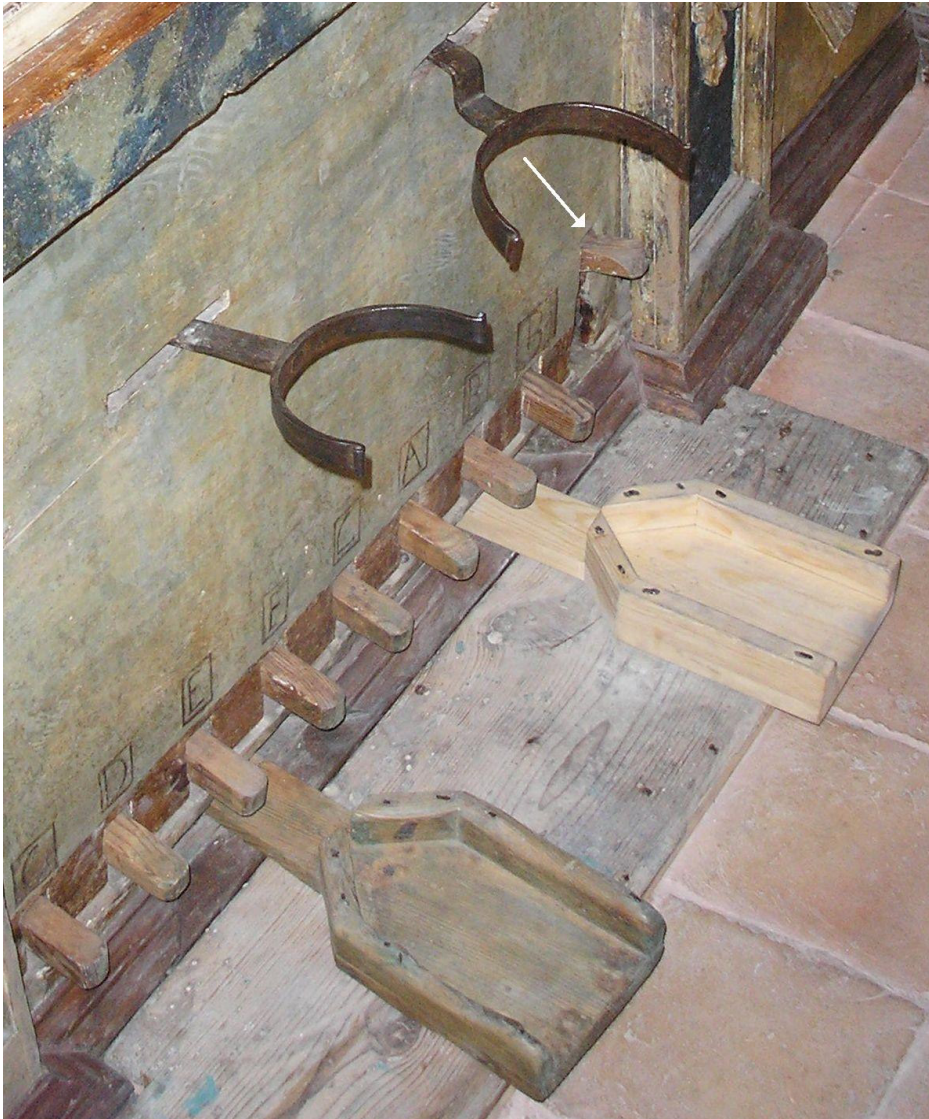
Rodillera (Kniehebel) zu den spanischen Trompeten, contras (für 8 Töne), Tritt zum Schweller (Holzstange), zapata (rekonstruiert) wechselt corneta real und corneta de eco. Die Orgel wurde 1790 gebaut. Erbauer nicht gekannt. Iglesia San Andrés de Baeza (Jaén) 36
