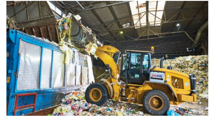
Befüllen Sortieranlage mit Gelber Sack-Sammlung, Quelle: Veolia
