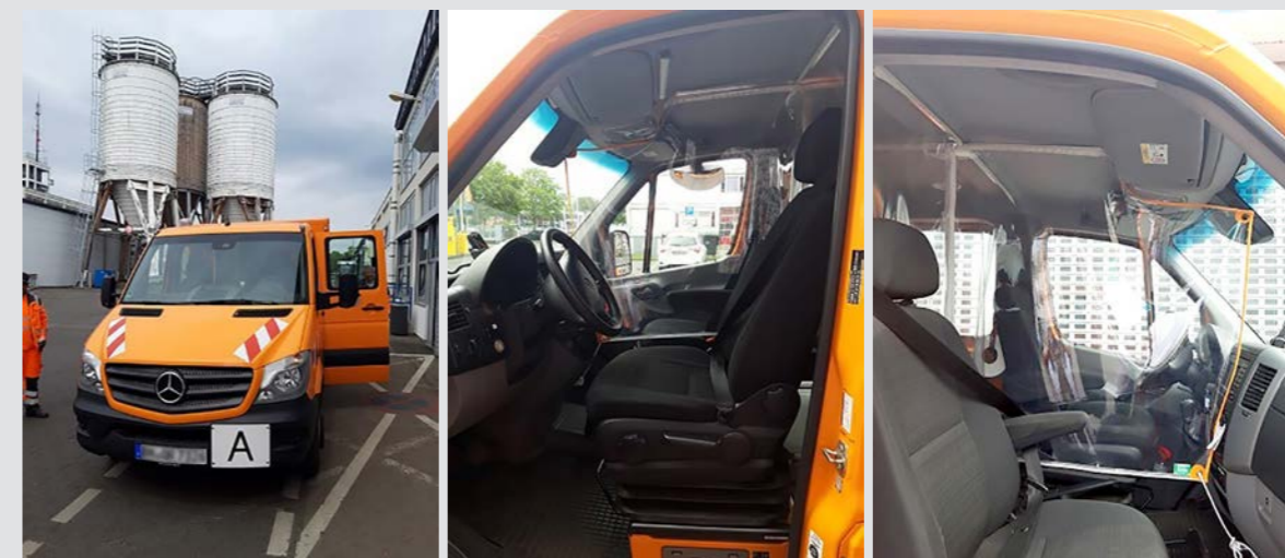
Abtrennungen im Fahrerhaus zum Mitarbeiterschutz, Quelle: bonnorange
