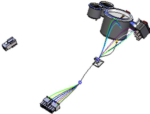
Der Befehl Bündel erstellt aus einem Satz von Drähten und Kabeln ein Kabelbaumbündel. Dadurch ergibt sich ein einzelner Pfad, der über mehrere Komponenten innerhalb der Kabelbaumbaugruppe hinweg erstellt werden kann. Zum Definieren des Pfades können Sie entweder einen Pfad durch die Festlegung von Punkten erstellen oder einen vorhandenen Pfad auswählen, der mit dem Befehl erstellt wurde. Für das Bündel in dieser Übung wurde der Pfad bereits erstellt.
