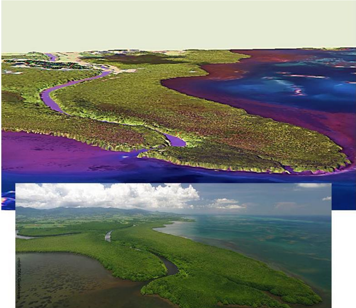
Figure 52-Représentation 3D de la hauteur des mangroves dans la Grande rivière à Goyave (Guadeloupe) avec un drapage d'une image WorldView-3 en fausses couleurs (en haut) et photographie aérienne prise en 2015 (DEAL Guadeloupe).
