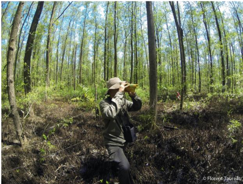
Figure 20-Utilisation d'un télémètre laser pour les mesures forestières. Deux hauteurs sont mesurables sur un arbre, la hauteur du fût, notée h , et la hauteur totale notée H
