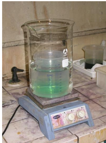
Figura 2.1 Disposizione del baker di reazione a bagnomaria in un recipiente di 5 litri, posto a sua volta a contatto con un fornello elettrico a piastra termoregolabile.
