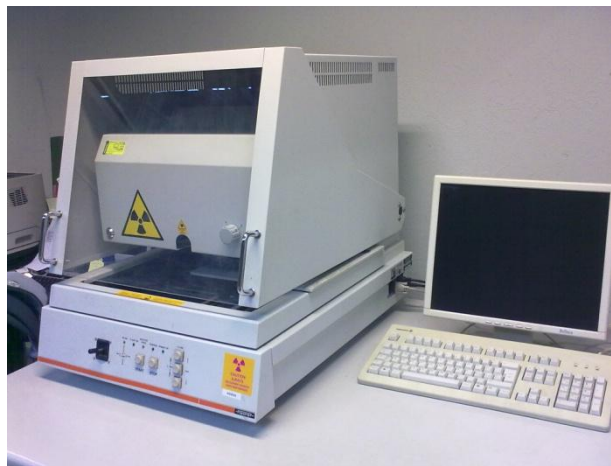
Figura 2.5 Fischerscope a fluorescenza di raggi X per la misurazione dello spessore di nichel depositato.
