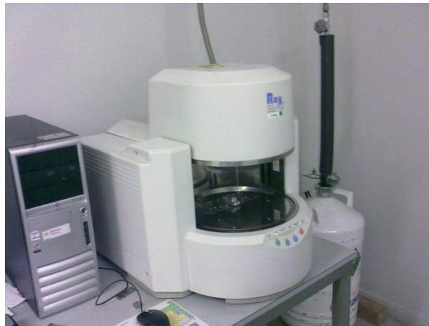
Figura 2.6 Shimadzu EDX-720, sonda a fluorescenza a raggi X per la misura della percentuale di fosforo nel deposito.
