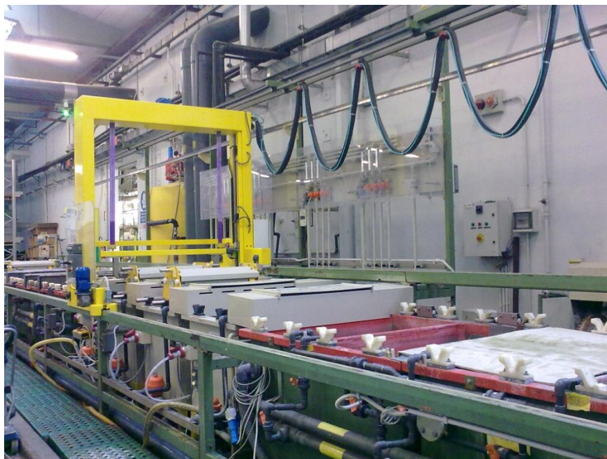
Figura 1.3. Linea adibita al processo di nichelatura chimica, nella quale sono visibili le vasche e il paranco giallo per il trasporto dei rotabarili.
