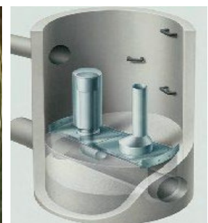
Abb. 23: automatische Schwallspülung für kleine Kanäle
