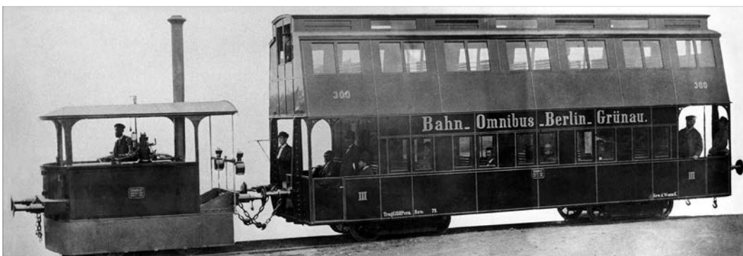
Bild 2 Im Jahr 1878 lieferte die Firma Krauß & Co. in München einen doppelstöckigen Wagen sowie eine Tramway-Lokomotive für die Berlin-Görlitzer Eisenbahn. Das Bild zeigt den Probetrieb des Wagens auf dem Münchener Werksgelände mit einer Tramway-Lokomotive ähnlicher Bauart, die allerdings nicht nach Berlin geliefert wurde. (Werkfoto Krauß, Sammlung Dirk Winkler)
