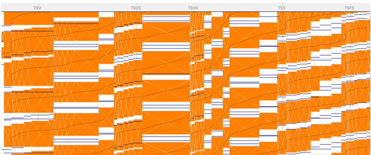
Abbildung 72: Sperrzeitentreppen zwischen Schwabstraße und Vaihingen
