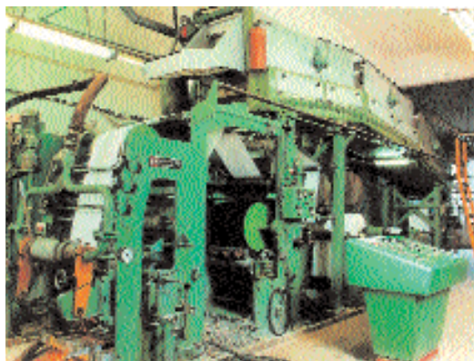
1968 wurde die Versuchsstreichmaschine von Bachofen & Meier im IZP in Betrieb genommen. Technikumsanlagen waren eine der Stärken des IZP bei der industrienahen Forschung und für die Aufnahme von Pilotproduktionen.
