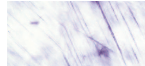
398. Kitöltött PDF-lemezek a Ries kráterből, Németország (Ries-kráter Múzeum, Nördlingen). A lemezek nagynyomású stishovit szemcséket tartalmaznak, melyek csak nagy nagyításokon mutathatók ki, TEM-felbontásokon.
