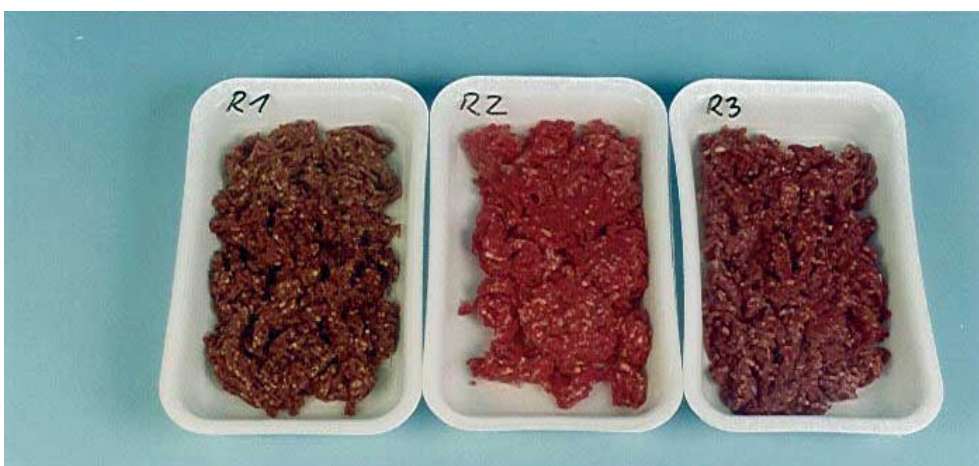
Abb. T11: Aussehen der O 2 -Kontrollcharge, CO-Versuchscharge und CO-100 % CO 2 -Versuchscharge nach 14 Tagen
