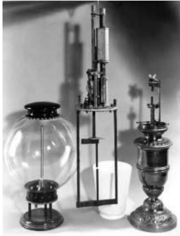
Abb. 11: Jablochkoffkerze und Bogenlampen von Siemens und Fein, 1880-1890.
