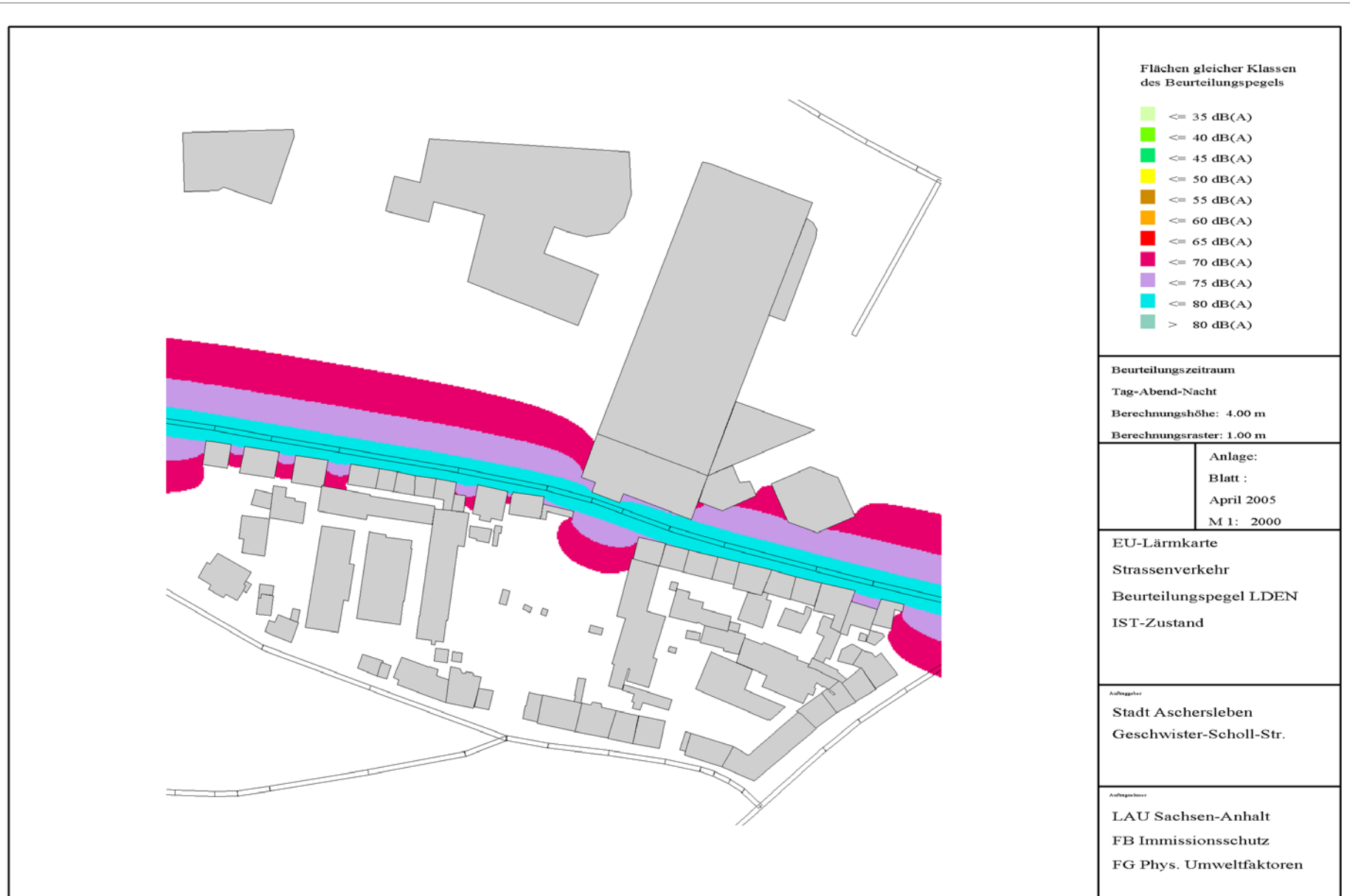
Abbildung 11.1: EU-Umgebungslärmkarte zur Darstellung des Beurteilungspegels L_{DEN} für den Bereich Geschwister-Scholl-Straße, Aschersleben Ist-Zustand 2001/2002 Beurteilungszeitraum 24 h
