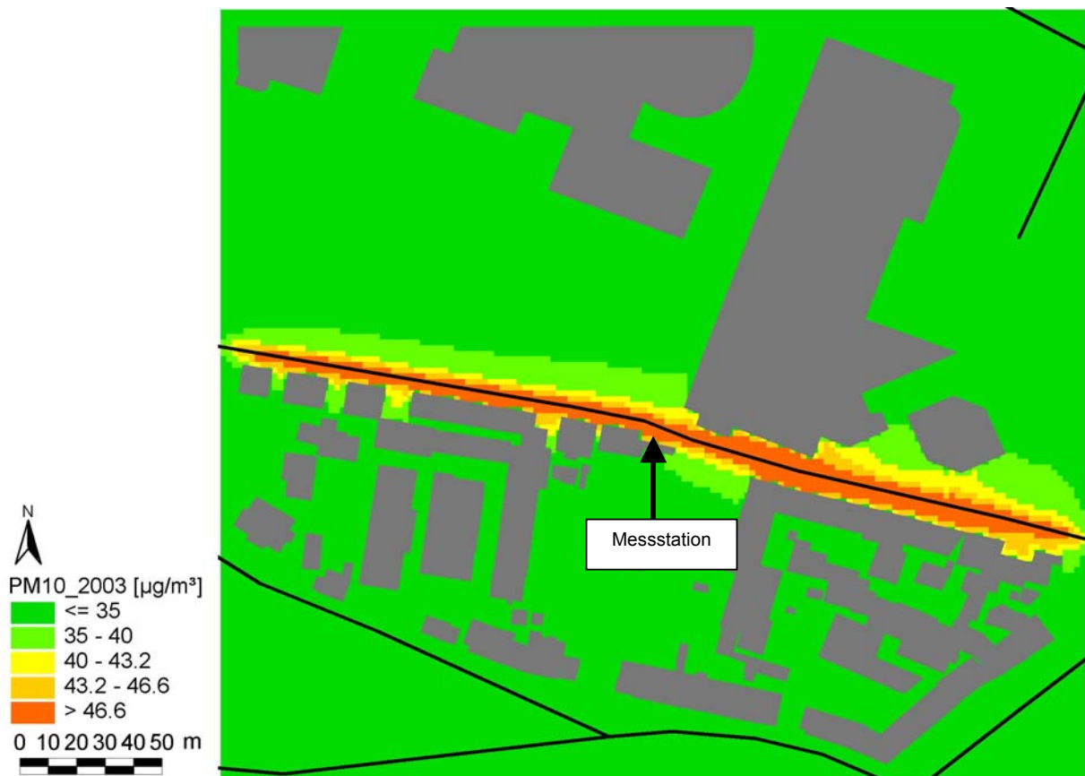
Abbildung 6.5.2.3: Räumliche Verteilung der Jahresmittelwerte 2003 von \text{PM}_{10} im Nahbereich der Messstation in Aschersleben berechnet mit LASAT
