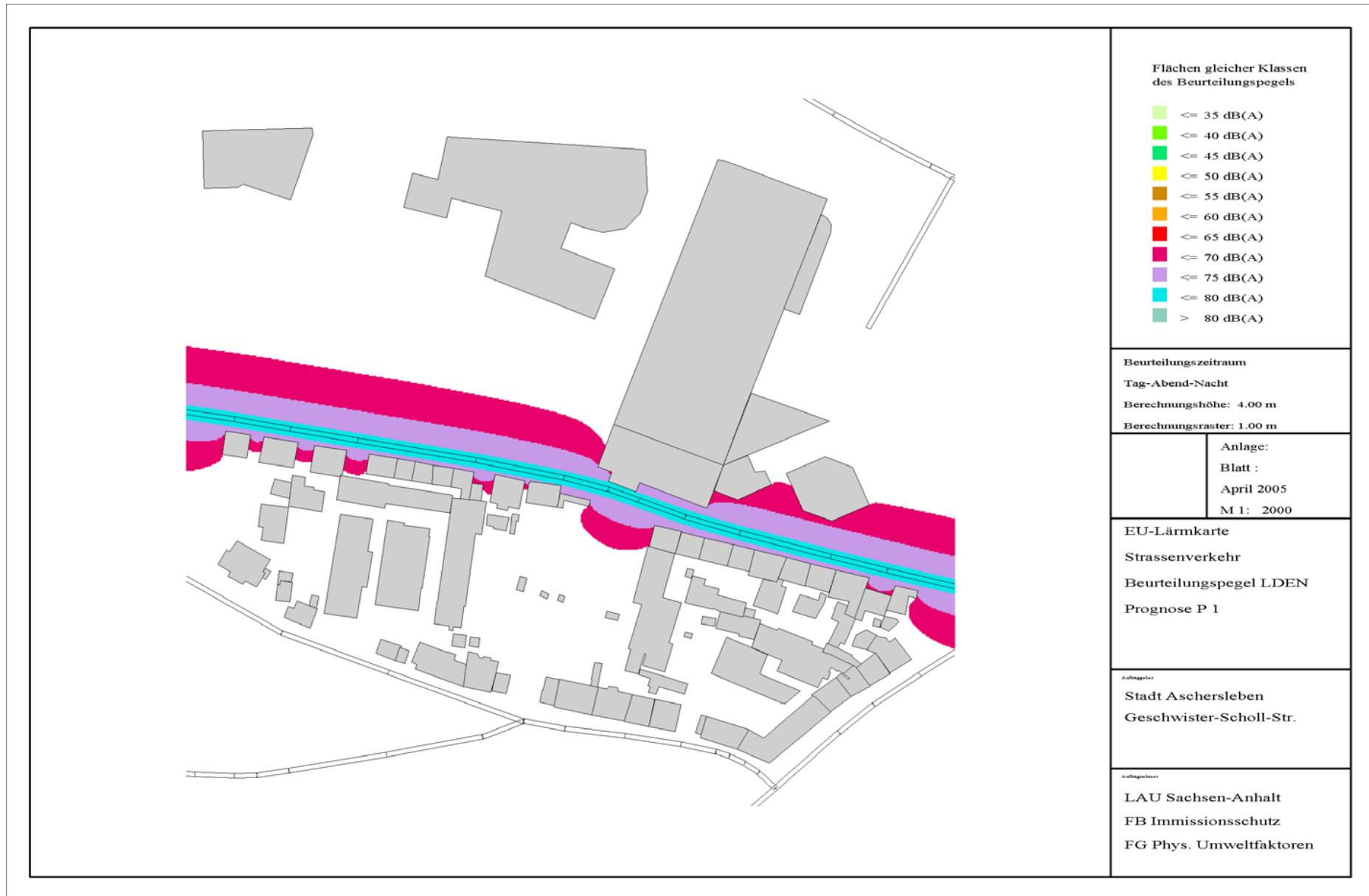
Abbildung 11.3: EU-Umgebungslärmkarte zur Darstellung des Beurteilungspegels L_{DEN} für den Bereich Geschwister-Scholl-Straße, Aschersleben Prognose P1 Beurteilungszeitraum 24 h
