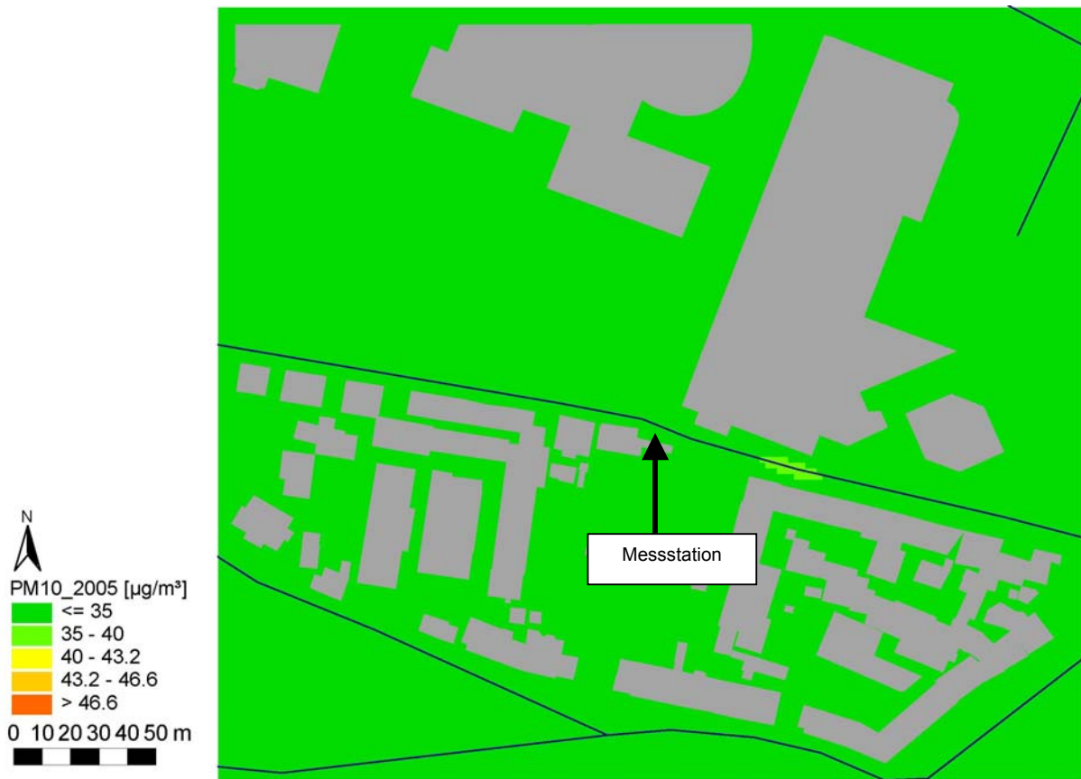
Abbildung 8.2.4: Räumliche Verteilung der Jahresmittelwerte 2005, Prognose der Planungsstufe 1 (Neubau B6n) von PM_{10} im Nahbereich der Messstation in Aschersleben, berechnet mit LASAT
