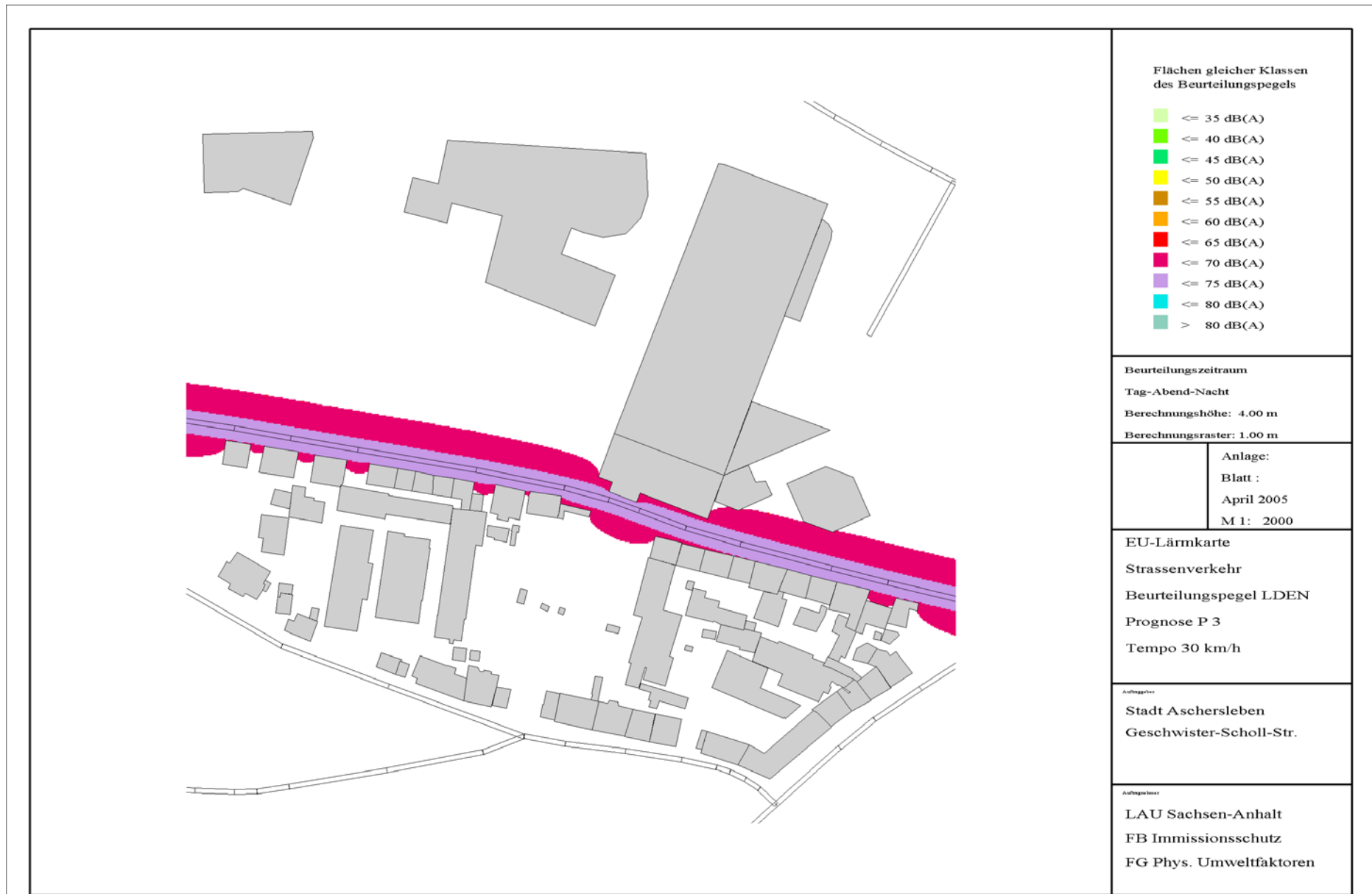
Abbildung 11.7: EU-Umgebungslärmkarte zur Darstellung des Beurteilungspegels L_{DEN} für den Bereich Geschwister-Scholl-Straße, Aschersleben Prognose P3-2 mit Tempo 30 km/h Beurteilungszeitraum 24 h
