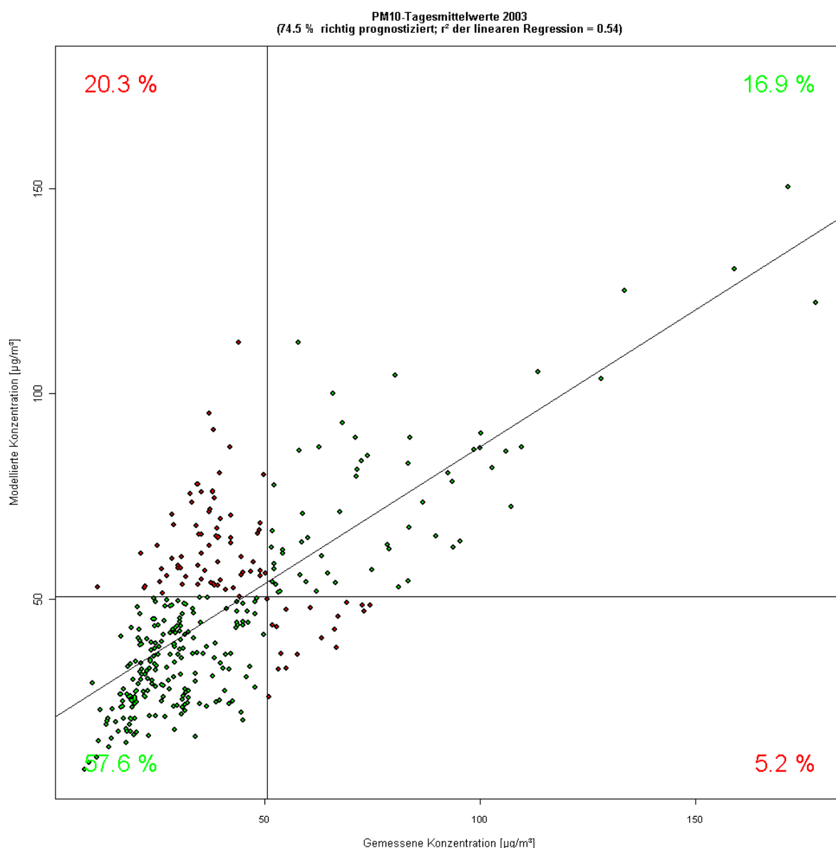
Abbildung 6.5.2.1: Paarweiser Vergleich der LASAT-Modellwerte und der Messungen in Aschersleben
