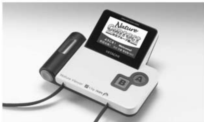
図表 3-9 日立製作所が愛知万博に出展している燃料電池を搭載した情報表示端末
