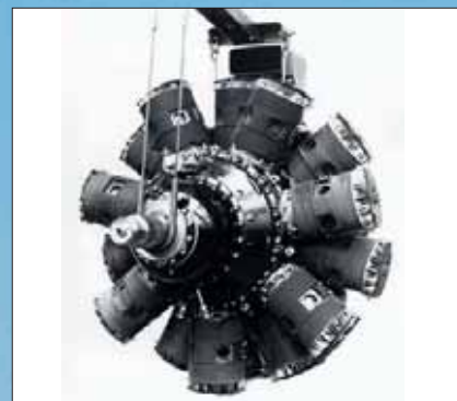
El motor Bristol Hercules 730 de 2.040 CV, elemento clave en la concepción del Azor. (Andrew Siddons, Rolls-Royce plc)
