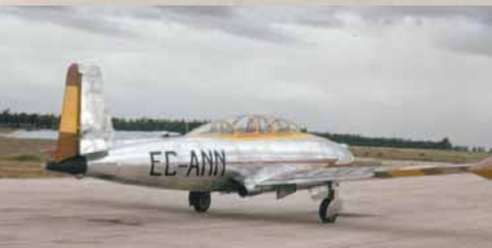
El segundo prototipo, denominado «Avión 20/2» en San Pablo, abril de 1957. Han desaparecido una decena de tomas de aire y se ensaya una carena de tubo sobre las dos que han quedado. Lleva los «tip tanks», decorados con un rayo blanco, y la matrícula civil EC-ANN. La deriva ha aumentado ya ligeramente su altura, aunque la aleta dorsal es todavía la del 20/1 y del Triana. (Foto: archivo del autor).
