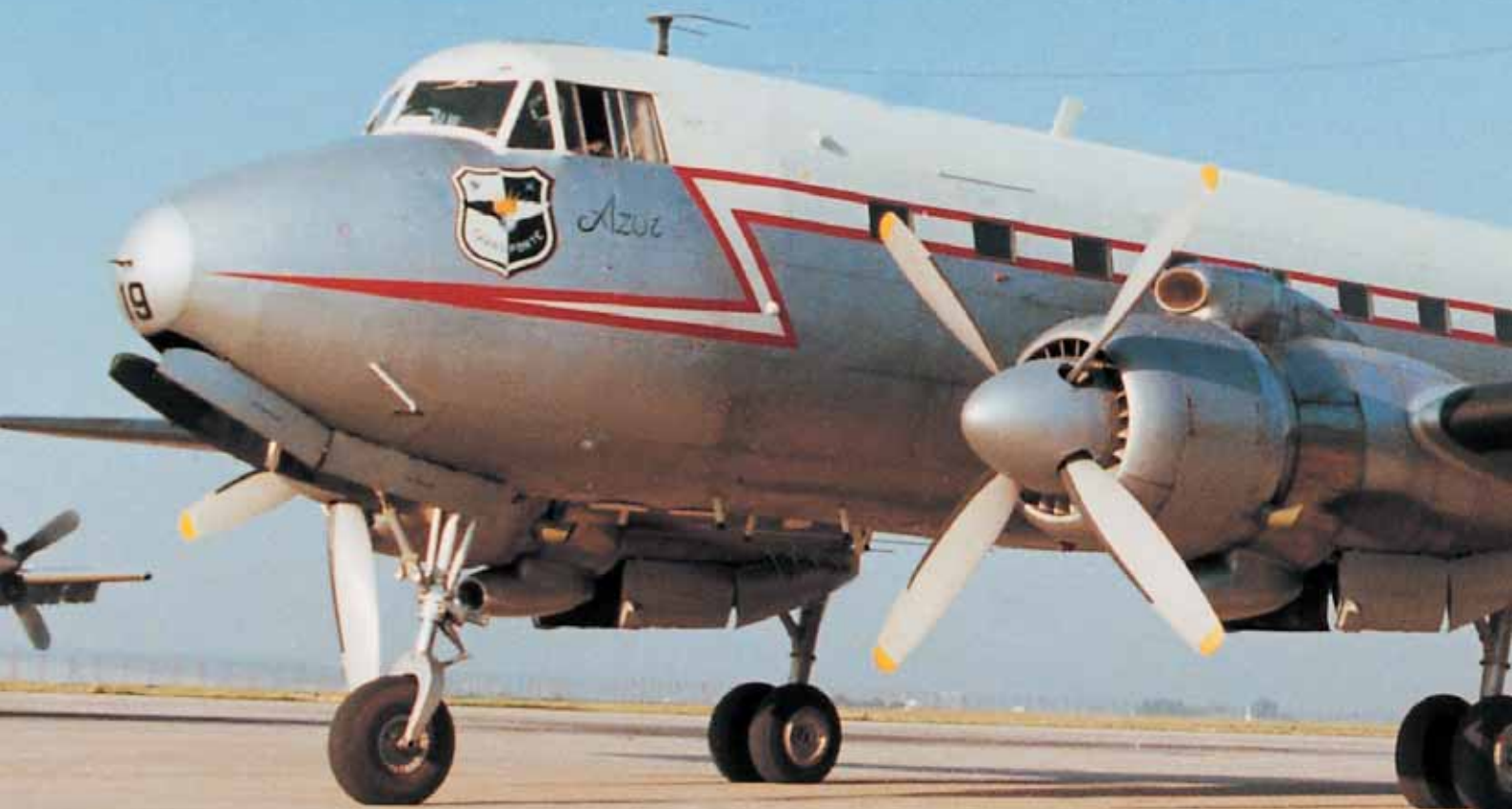
El motor Bristol Hercules 730 de 2.040 CV, elemento clave en la concepción del Azor. (Andrew Siddons, Rolls-Royce plc)
