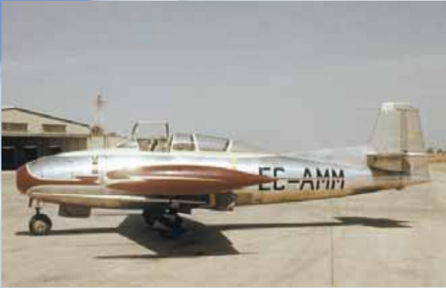
El 201, ya con tanques de bordes marginales —sobre los que aparece un estilizado rayo de color blanco— mientras ensaya una aleta de deriva de grandes dimensiones: de hecho, se prolonga hasta el extremo de la cúpula. El avión ya ha sido exhibido en varios países europeos y luce sus banderas. (Foto: archivo del autor).
