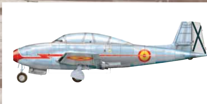
Perfil del prototipo 20/1, antes de recibir los tanques de bordes marginales. La aleta de deriva es todavía la de los prototipos números 1 del Triana. Nótese la ausencia del antishimmy en la pata de la rueda de morro y la forma y situación de la compuerta del alojamiento de dicha rueda. (Ilustración: © J.A. Guerrero).
