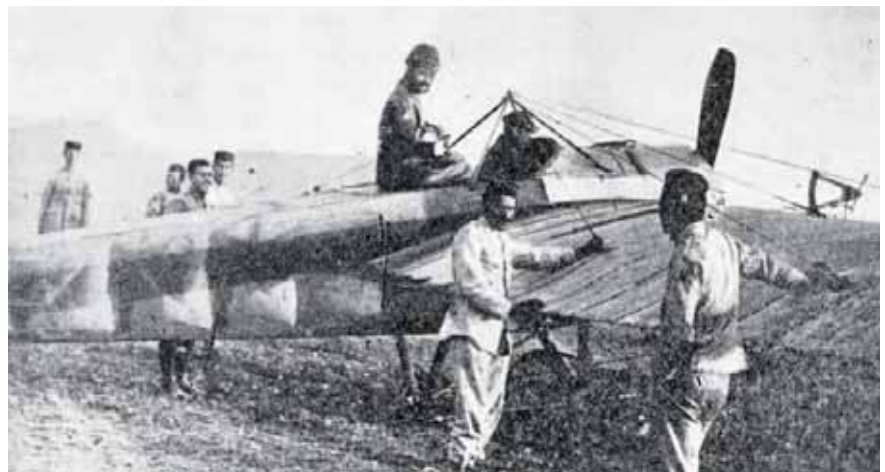
Un Nieuport va a despegar en una misión de bombardeo. Obsérvese el visor montado en el borde de ataque del plano derecho.
