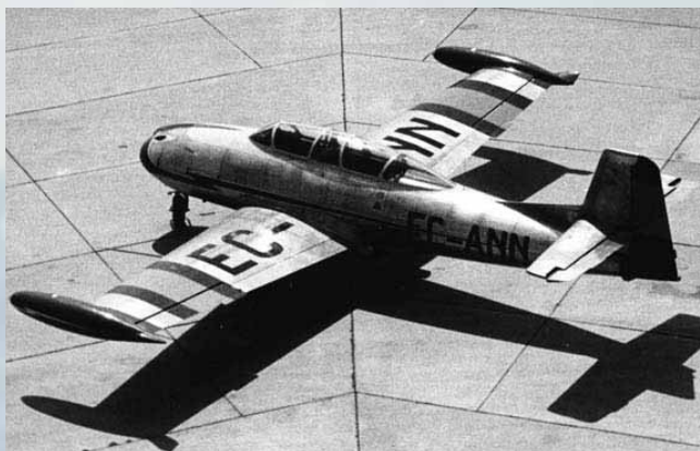
El 20/2 fotografiado el 30 de agosto de 1957. Así había sido exhibido por Fernando de Juan en el Salon Aeronáutico de París, dos meses antes. El timón sigue siendo redondeado en el borde marginal superior, pero la carena dorsal de cola y la espina longitudinal del capó ya son definitivas. Las tomas de aire también son más parecidas a las finales. (Foto: archivo del autor).
