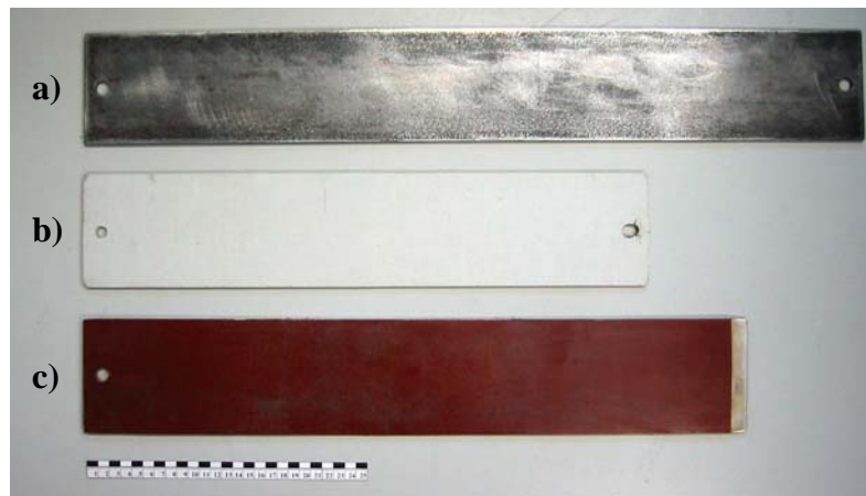
a) Stahlplatte, b) Kunststoffplatte, c) phenolharzbeschichtete Furnierholz-Platte
