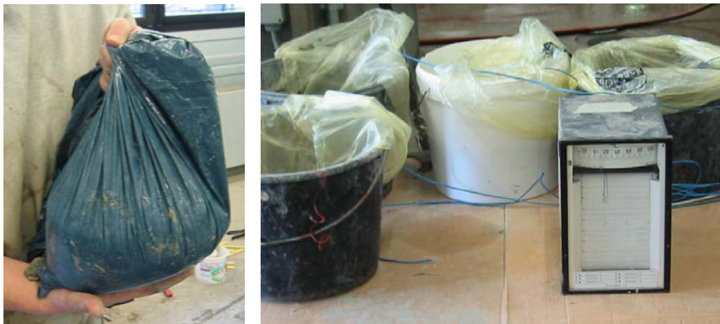
Bild 4.79: Prüfung der Erstarrungszeiten mit dem Knetbeutelverfahren und Aufnahme des Temperaturverlaufs (v.l.n.r)
