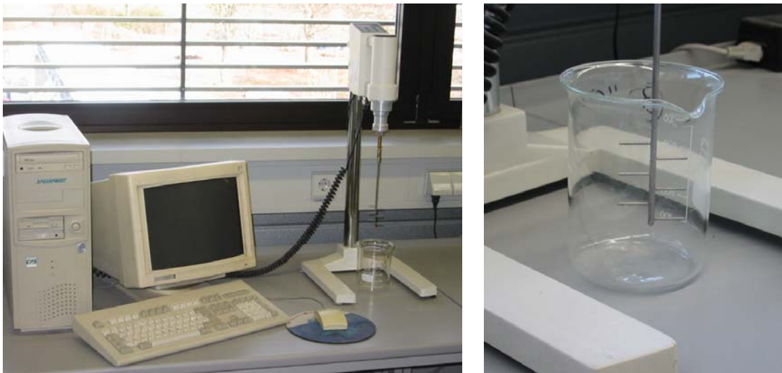
Bild 4.13: Rheometer HAAKE VT 550 mit Stiftrührer und Glasbehälter
