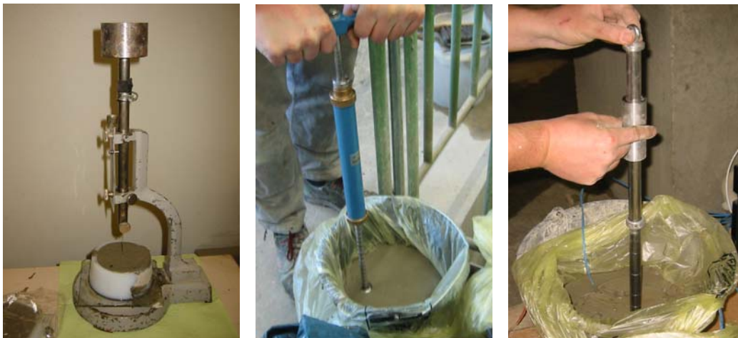
Bild 4.78: Prüfung der Erstarrungszeiten mit Vicat-Penetrationsversuch, mit Penetrationsversuch nach ASTM C 403 (2005) und mit Humm-Sonde (v.l.n.r)
