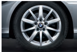
□ 17" Leichtmetallräder 1 Sternspeiche 286 mit Mischbereifung und Notlaufeigenschaften, vorn 8 J x 17 mit Bereifung 225/45 R 17, hinten 8,5 J x 17 mit Bereifung 255/40 R 17.
