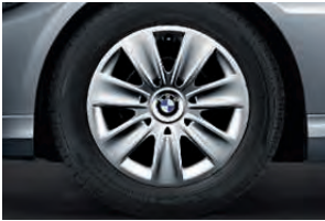
■ 16" Stahlräder mit Radvollblende 1 , 7 J x 16, Bereifung 205/55 R 16 (für 318i, 320i, 316d und 318d), auch als Winterkomplettadsatz im Original BMW Zubehör erhältlich.
