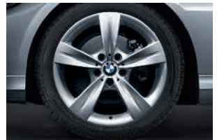
□ 18" Leichtmetallräder 1 Sternspeiche 287 mit Mischbereifung und Notlaufeigenschaften, vorn 8 J x 18 mit Bereifung 225/40 R 18, hinten 8,5 J x 18 mit Bereifung 255/35 R 18.
