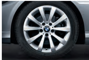
□ 17" Leichtmetallräder 1 V-Speiche 285 mit Notlaufeigenschaften, 8 J x 17, Bereifung 225/45 R 17 (Serie für 325i xDrive, 330i, 335i, 325d, 330d und 335d).
