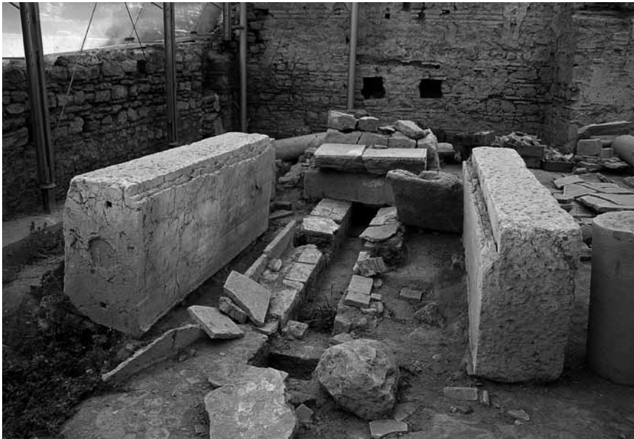
Abb. 3 Ephesus. Spuren einer mit zwei Sägeblättern bespannten Gattersäge in zwei Marmorblöcken; 6. Jh. n. Chr.
