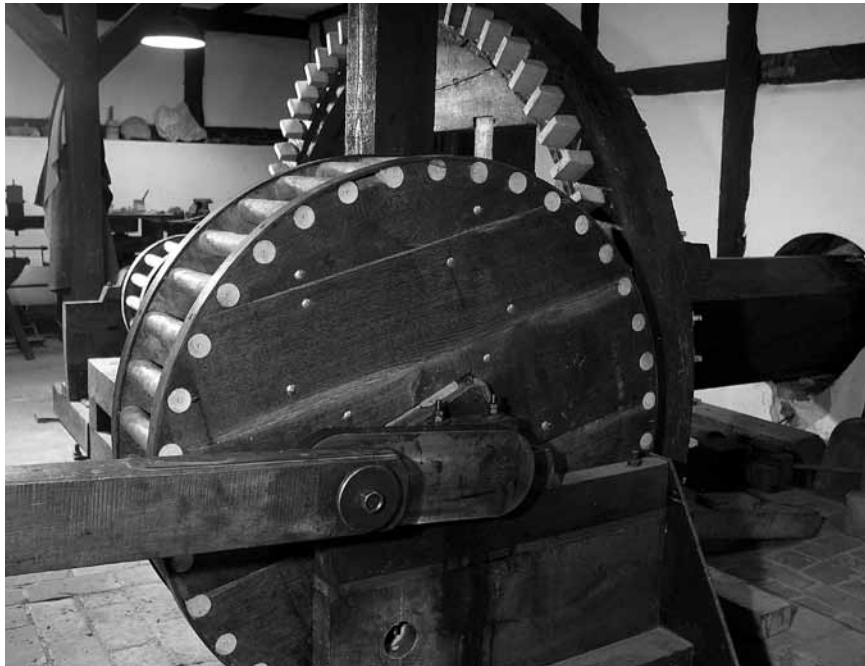
Abb. 18 Alte ›Schleifmühle‹ in Schwerin. Die Kraftübertragung vom Zahnrad über Drehling und Schubstange auf den Sägeschlitten entspricht im Wesentlichen der Darstellung auf dem Ammianos- Relief. (Lediglich das Kammrad des Getriebes im Relief ist hier durch ein Kronrad ersetzt.).
