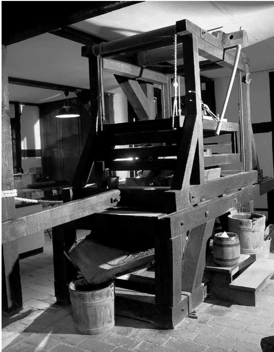
Abb. 17 Alte ›Schleifmühle‹ in Schwerin. Nach historischen Vorbildern nachgebaute Steinsäge.
