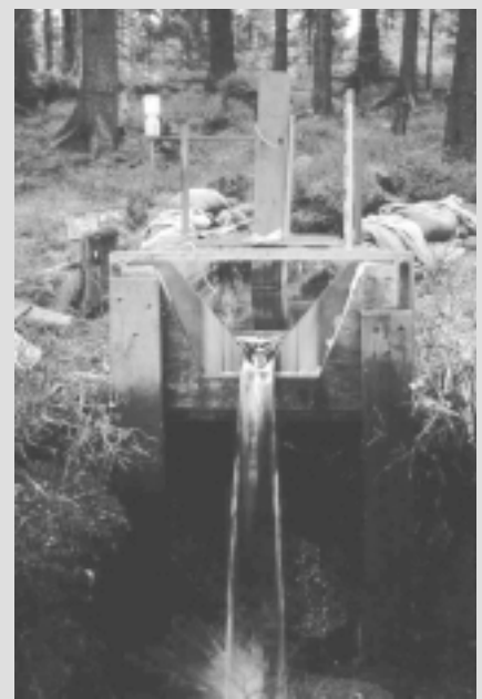
Die Abbildung oben zeigt das ITNI-Meßsystem (Integral Total Nitrogen Input). Auf der Abbildung unten ist ein Meßwehr zur Erfassung der Abflussmenge zu sehen.
