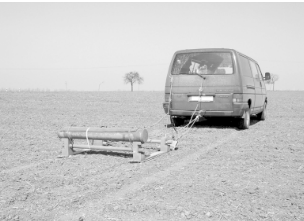
Die Abbildung links zeigt den Bodenscanner EM 38 im Einsatz auf einem Schlag des Lehr- und Versuchsgutes Görzig.
