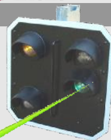
Lichtstärke und Lichtfarbe von Eisenbahnsignalen müssen mit Messgeräten einer vorgegebenen Güteklasse gemessen werden. (EN12368). Der X4 Light Analyzer von Gigahertz-Optik ist auch für LED Leuchten geeignet.
