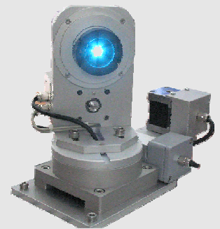
Kompaktes Goniophotometer zur Messung der Lichtstärke Verteilung von LEDs oder der Leuchtdichte Verteilung von Displays.
