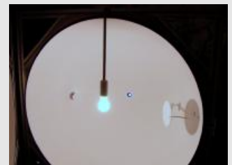
Lichtstrommessung in einer Ulbrichtkugel mit einem Meter Durchmesser
