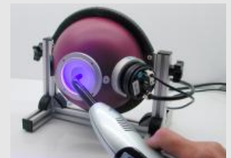
Strahlungsleistung und Spektrum Messung eines UV-A Hochleistungsstrahlers für die Strahlenhärtung Dentaler Füllungen
