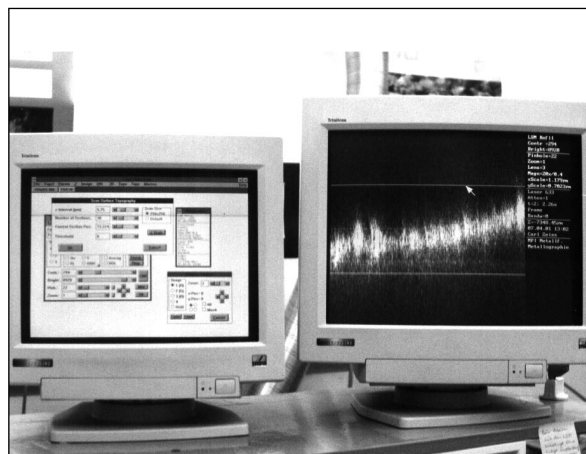
Abb. 44 – Display zur Prüfung des reflektierenden z-Bereiches und zur Einstellung der z-Intervalle
