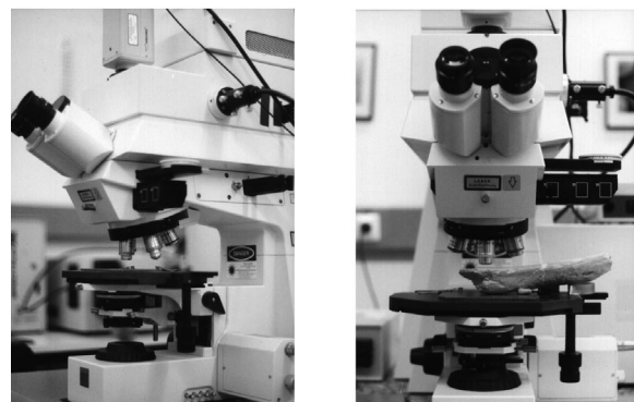
Abb. 42 – Auflicht-Laserscan-Unit; rechts bei maximaler Höhe des Untersuchungsobjektes, d.h. der Objektträger ist bis zum Anschlag nach unten gefahren.
