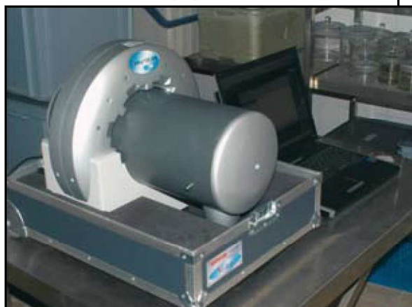
Abb. 2: Trommelscanner zum Auslesen der Speicherfolien und Laptop mit Bildbearbeitungssoftware
