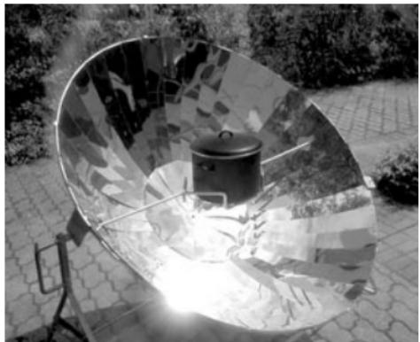
*solarno kuhalo s paraboličnim zrcalom*
