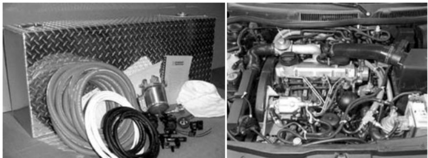
*oprema potrebna za preradu vozila na biljno ulje može se kupiti u kompletu*
