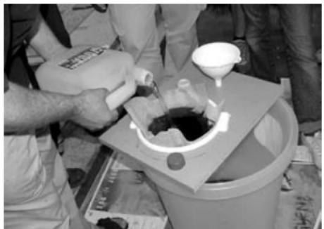
*filtriranje iskorištenog jestivog ulja u procesu proizvodnje biopower goriva*
