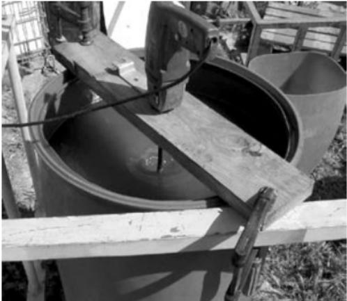
proizvodnja biodizela u kućnoj radinosti uz pomoć jednostavnog procesora
