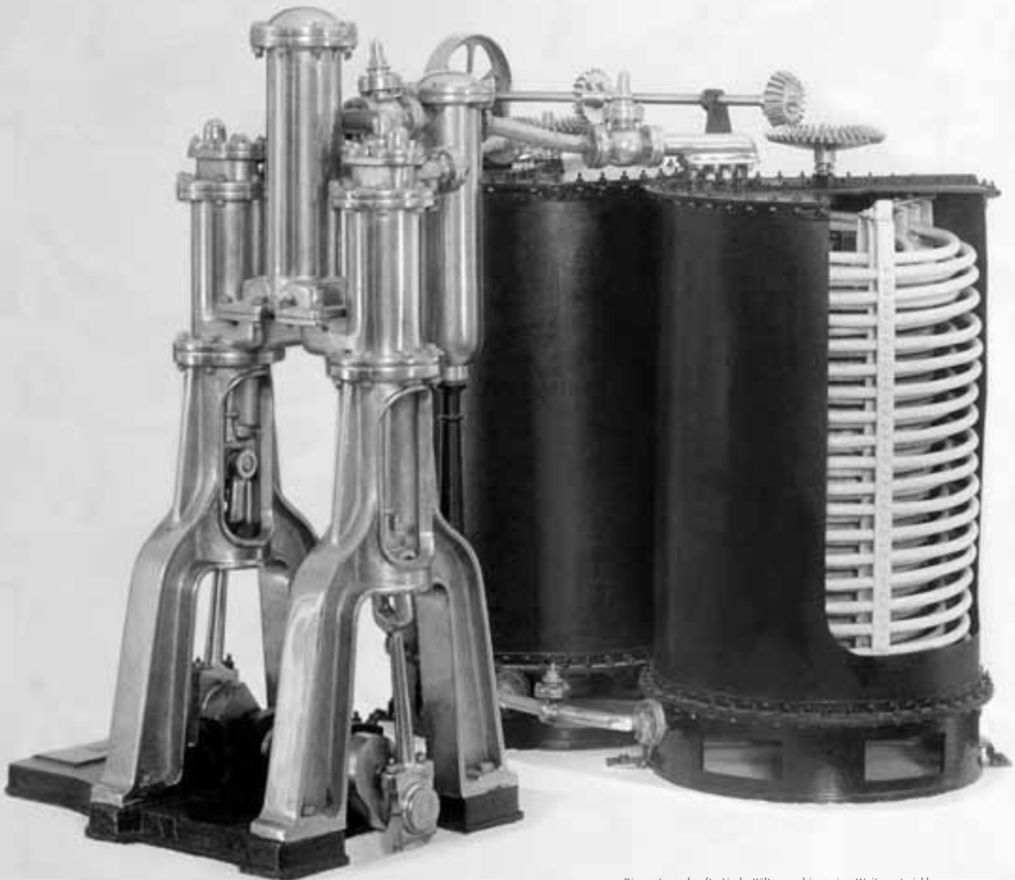
Die erste verkaufte Linde-Kältemaschine, eine Weiterentwicklung des Ursprungsmodells von 1873, kam 1877 bei der Dreher'schen Brauerei in Triest (Italien) zum Einsatz.
