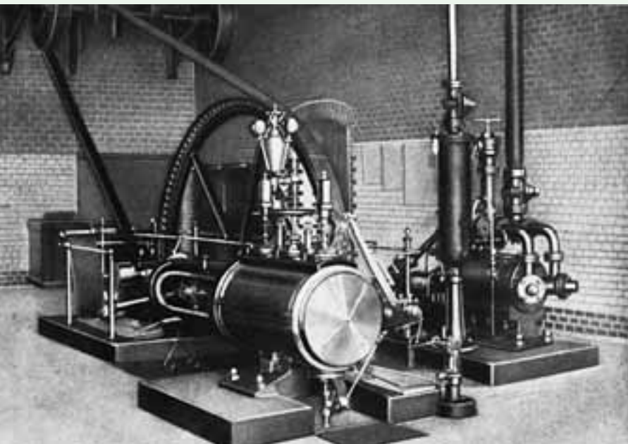
1883 rüstete die Gesellschaft für Linde's Eismaschinen den Schlachthof Wiesbaden als ersten Schlachthof mit einer Kältemaschinenanlage aus.
