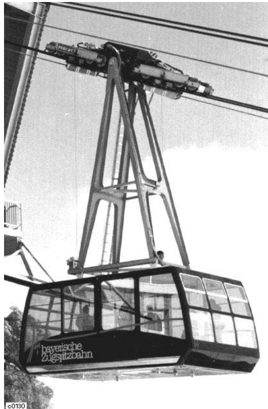
Ausführung für stützenfreie Trasse
