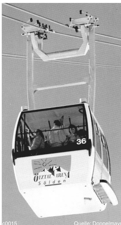
DLM Gaislachkogelbahn; Doppel-Einseilumlaufbahn mit schmaler Spurführung
