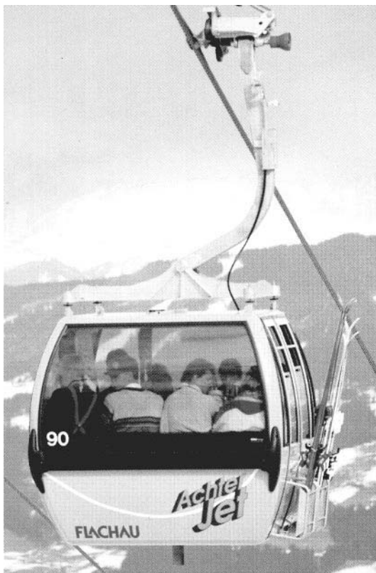
Einseilumlaufbahn mit kuppelbaren 8er-Kabinen
