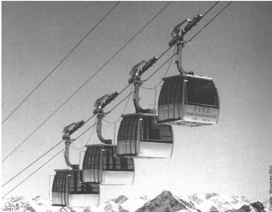
Zweiseilgruppenumlaufbahn: eine von 4 Wagengruppen zu mehreren Kabinen
