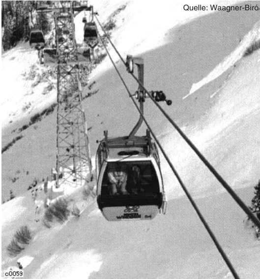
Zweiseilumlaufbahn mit einem Tragseil Fahrzeuge: 2er, 4er, 6er, 12er-Kabinen
