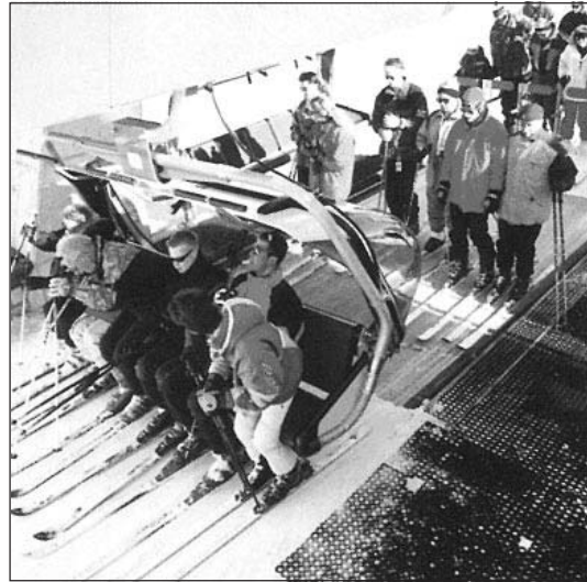
Förderbandeinstieg einer kuppelbaren 6er-Sesselbahn
