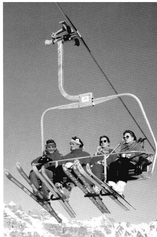
Einseilumlaufbahn mit kuppelbaren 4er-Sesseln
