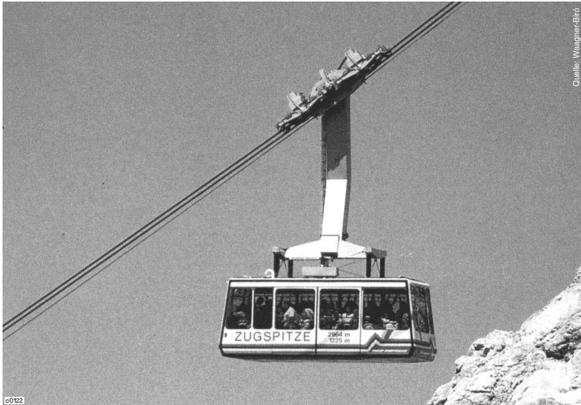
Zweiseilpendelbahn zur Zugspitze (von österreichischer Seite aus) mit Großkabine für 100 Personen
