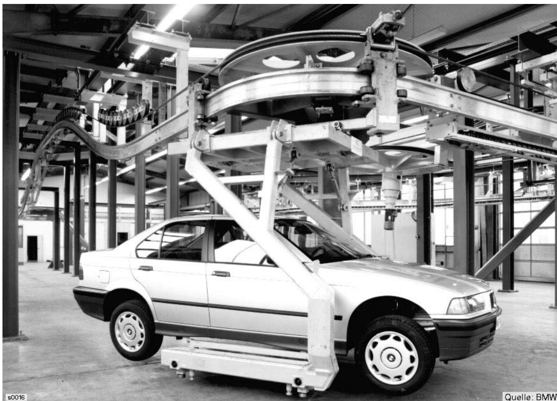
Seil-Hängebahn in einem Automobilwerk
