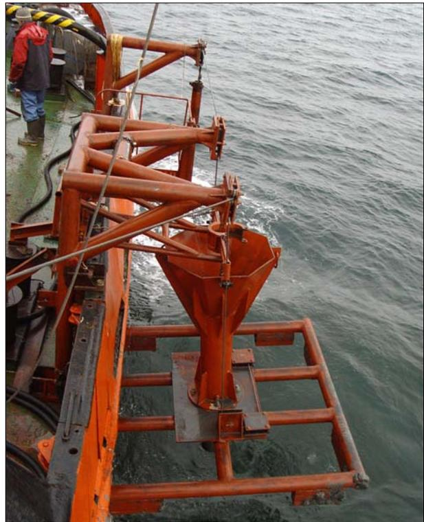
Рис. 5. Донная рама с направляющей воронкой перед спуском на дно.
