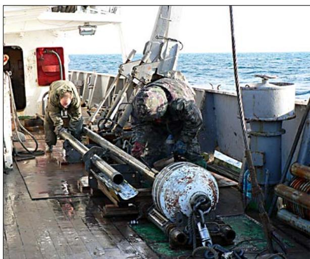
Рис. 12. Гидростатическая трубка.
