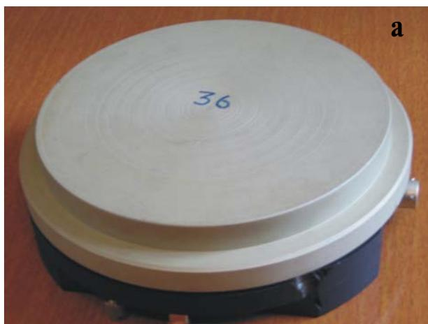
Рис. 4. Станция «Черепашка» (а) с пьезодатчиками (б). Диапазон регистрируемых частот 0,5–17000 Гц.
