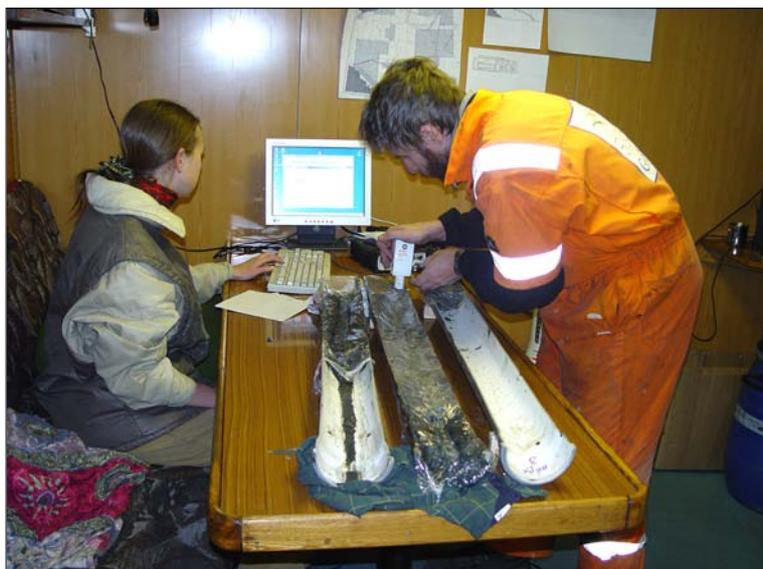
Рис. 12. Исследование магнитных свойств кернов буровой скважины с помощью капометра.
