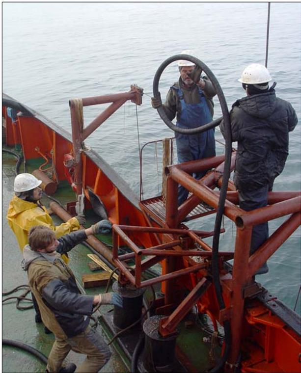
Рис. 4. Буровая бригада у направляющих стоек при опускании бурового снаряда.
