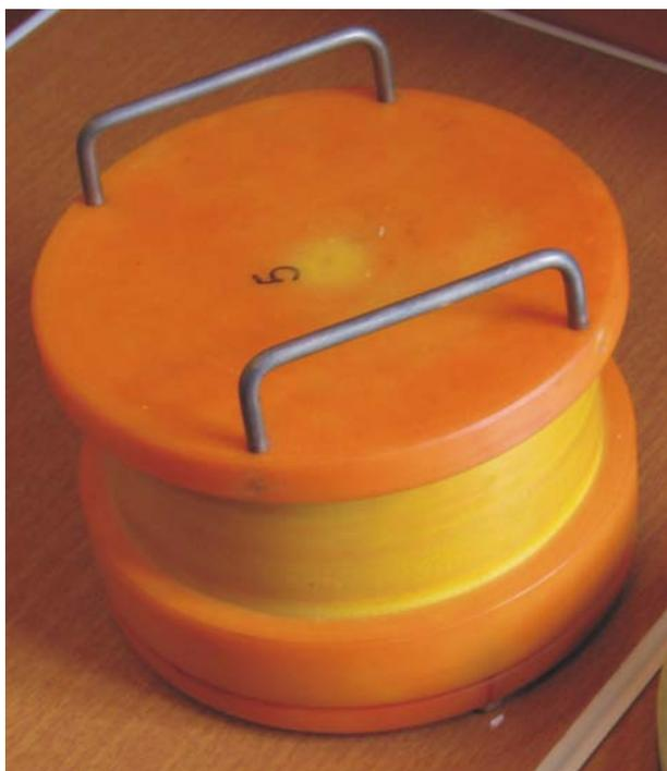
Рис. 3. Станция ГНОМ на базе геофонов. Диапазон регистрируемых частот 0,05–400 Гц.
