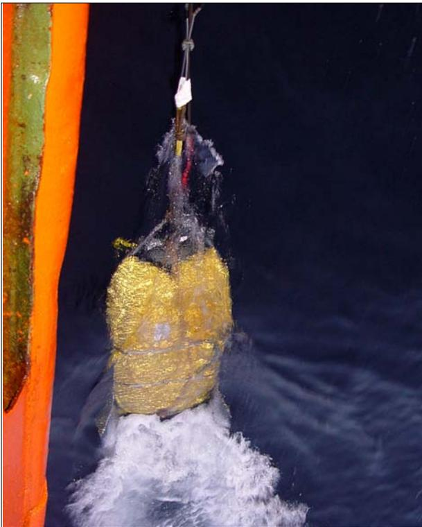
Рис. 2. Буксируемый модуль гидроакустического комплекса.
