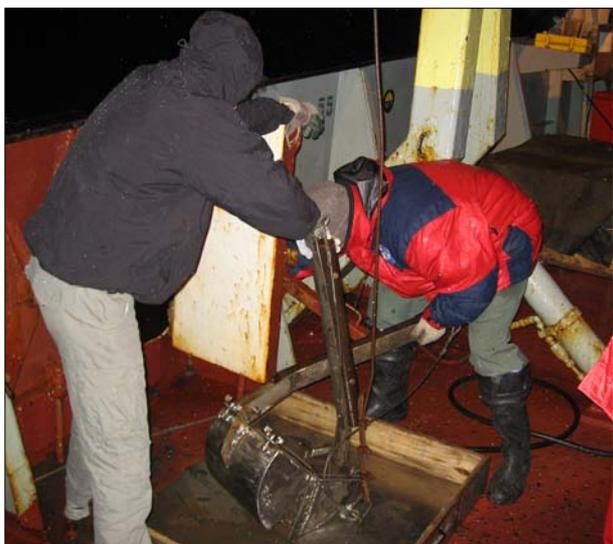
Рис. 4. Опробование донных отложений дночерпателем Van-Veen.
