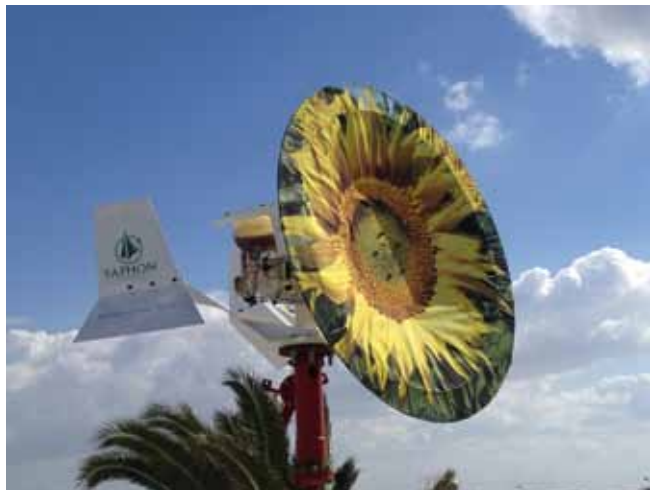
Abbildung 7: Modell einer Kleinwindanlage von Saphon Energy, Photo: Saphon Energy
