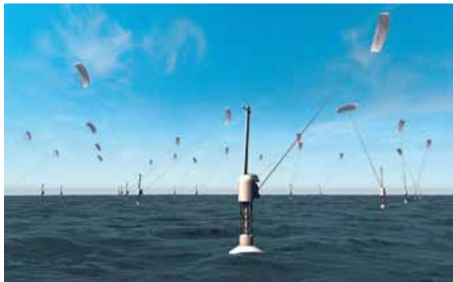
Abbildung 6: Kombinierte Lenkdrachensysteme zur Stromerzeugung, Photo: SkySails GmbH
