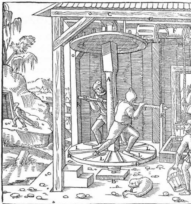
Abb. 3 Stehende Welle: Die runde Scheibe
