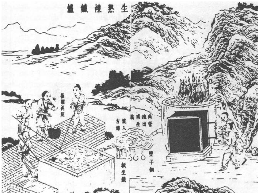
Abb. 2 Chinesischer Hochofen (1637). Rechts der von Hand betriebene zwei-fach wirkende Kolbenblasebalg, mit dem Luft eingeblasen wird. Einige Schriftzeichen in der Mitte beziehen sich auf "herausfallende Stahlklumpen", also zähflüssige Eisenschmelze mit mittlerem Kohlenstoffanteil, die später durch Zusammenschmelzen zu Stahl weiterverarbeitet wurde. Dieses Verfahren wurde im 5. Jh. n. Chr. entwickelt. Es entspricht grundsätzlich dem Siemens-Martin-Verfahren, das 1863, also 1400 Jahre später, erfunden wurde.
