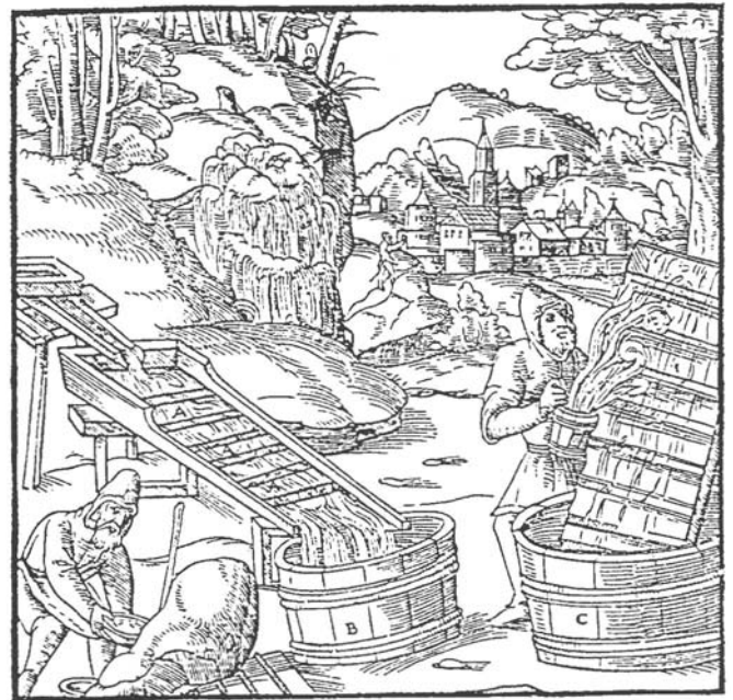
Abb. 18b Goldwaschen: Zeitlos vom alten Aegypten bis zur Neuzeit Die Querrinnen A. Das Unterfass B. Das andere Fass C. (AGRICOLA)
