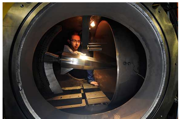
Untersuchung der Nutzlastspitze im Windkanal
