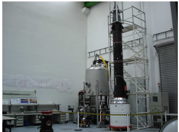
Shefex II Nutzlast montiert auf der 2. Stufe. (Modell des Gesamtsystems im Maßstab 1:6 links daneben)
