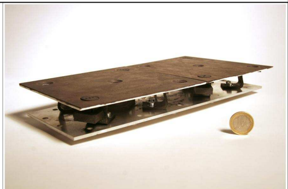
Aufbau einer keramischen Thermalschutz-Facette
