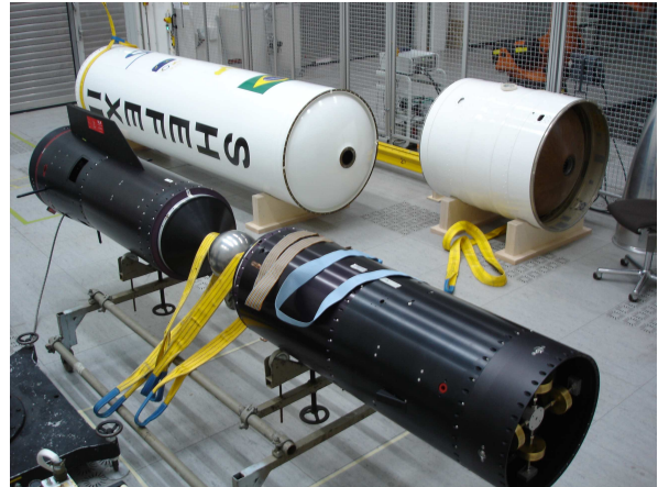
Brasilianische Raketenmotoren der 1. und 2. Stufe (weiß) sowie Servicemodule der Nutzlast (schwarz).
