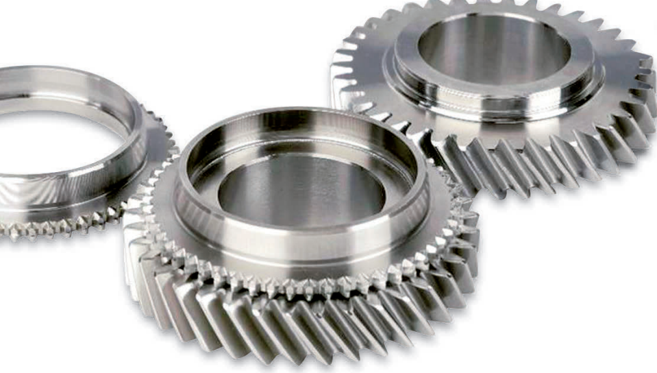
Schaltrad mit aufgeführter Synchronisierung bestehend aus warmumgeformtem Gangrad und warmumgeformter und bearbeiteter Synchronverzahnung
