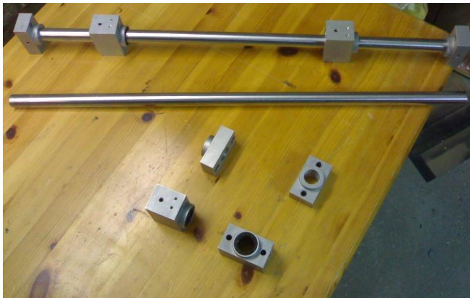
**Abb. 10: Linearführungen der Y-Achse**
