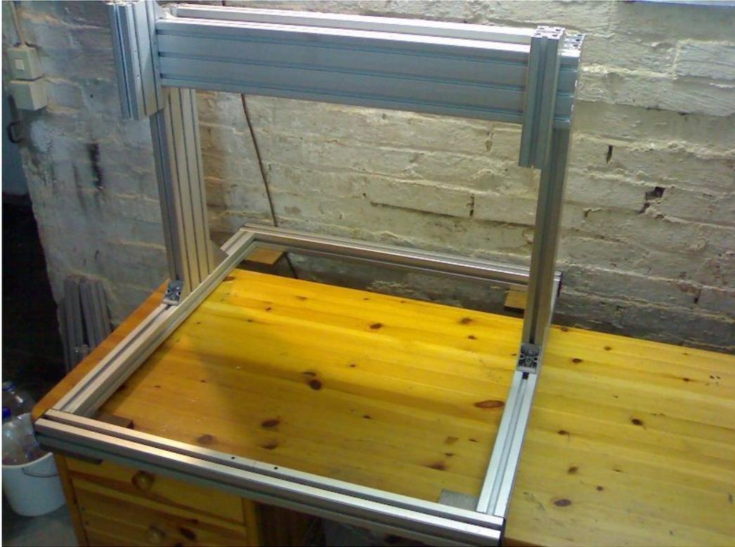
**Abb. 3: Frontansicht der Rahmenkonstruktion**
