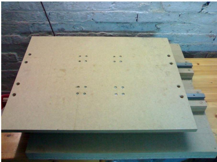
**Abb. 8: Linearführungen X-Achse**
