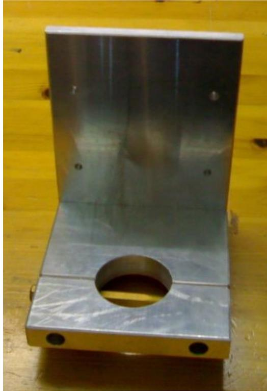
**Abb. 12: Fräsmotoraufnahme
