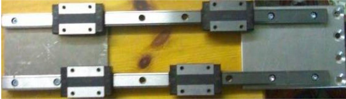
**Abb. 9: Linearführungen an der Z-Achse**
