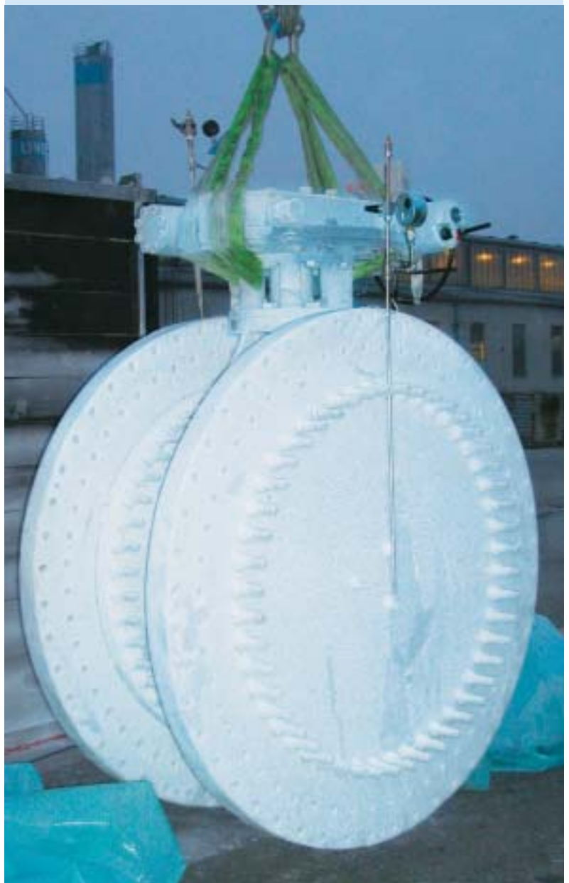
Abb. 4: Die neu entwickelte Hochleistungs-Absperrklappe für Rohrleitungen mit tiefkalten Flüssigkeiten von Linde-MAPAG
