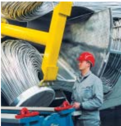
Teilansicht eines gewickelten Wärmetauschers in der Fertigung (Seite 14).
