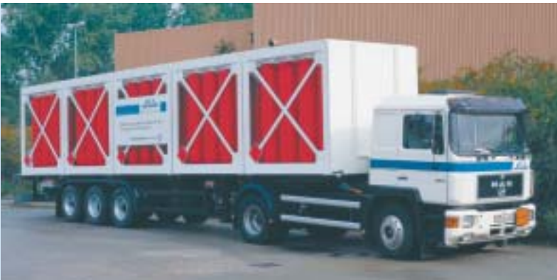
Abb. 4: Lkw mit GH 2 -Anhänger (Gesamtgewicht 40 Tonnen, Wasserstoff-Nutzlast 530 kg bei 20 MPa).
