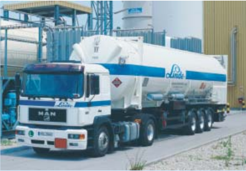
Abb. 3: Anhänger für den LH 2 -Transport (Gesamtgewicht 40 Tonnen, Wasserstoff-Nutzlast 3.370 kg). Mit dem LH 2 -Anhänger kann sechsmal mehr Wasserstoff als mit dem GH 2 -Anhänger befördert werden.
