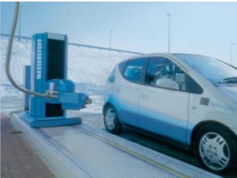
Abb. 8: Für die weltweit erste Flüssigwasserstoff-Tankstelle am Flughafen München hat Linde die vollautomatische Tankanlage errichtet und stellt zudem den nötigen Flüssigwasserstoff bereit.
