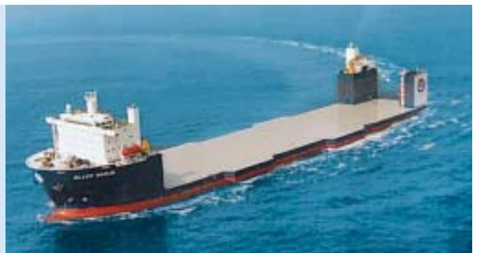
Abb. 9: Typisches Heavy Lift Vessel (HLV) als potentieller Carrier für die Prozessbarge.
