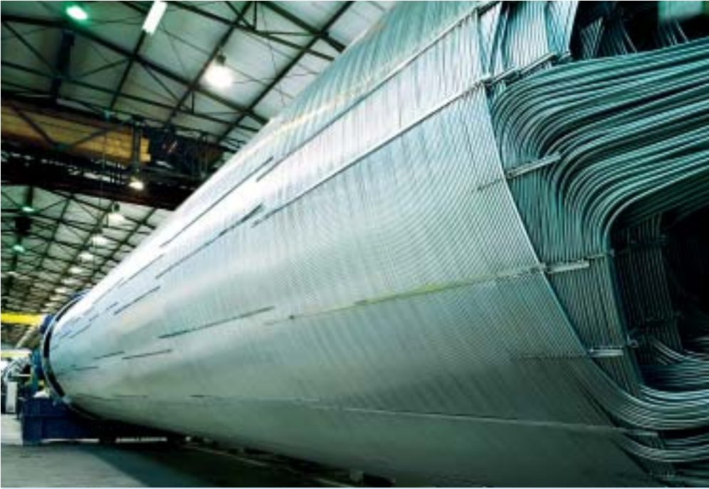
Abb. 4: Typischer gewickelter Wärmetauscher für LNG- Anlagen.
