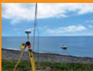
Suivi topo-bathymétrique au moyen d'un GPS différentiel couplé à un échosondeur
