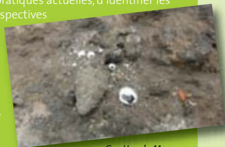
Gouttes de Mercure sur un site historique de productions de chlore par électrolyse dans des cellules à mercure (D. Hube)
