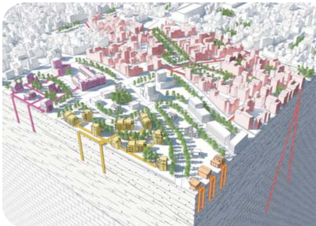
Géothermie sur nappe, du particulier au réseau de chaleur. © Vertigo 3D/BRGM
