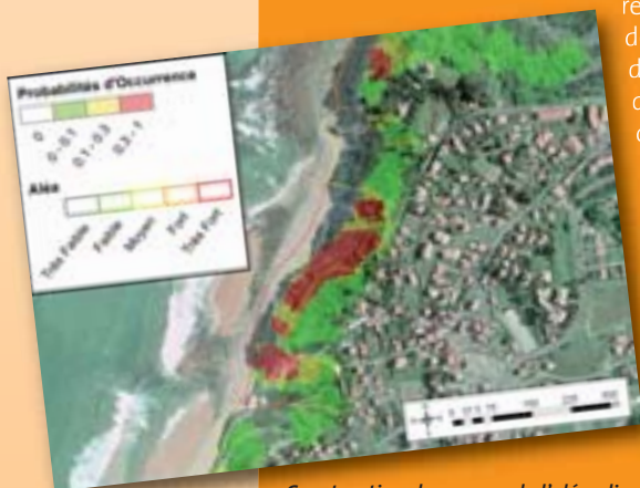
Construction du zonage de l'aléa glissement de terrain à l'aide du logiciel ALICE®.
