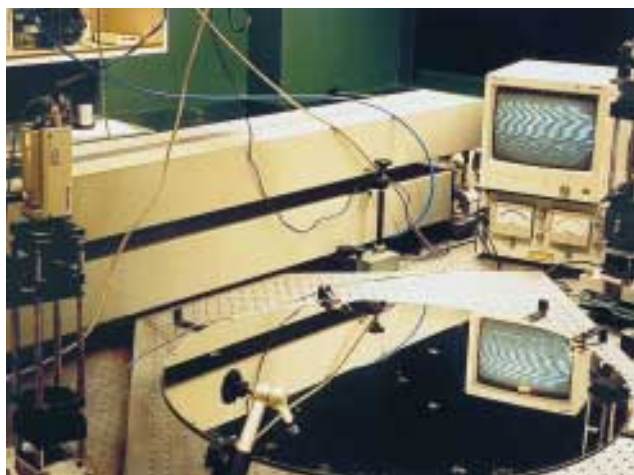
Bild 6: Interferometrische Prüfung der Spiegel für die Projektion des Sonnenspektrums an der Friedrich-Schiller-Universität Jena.
