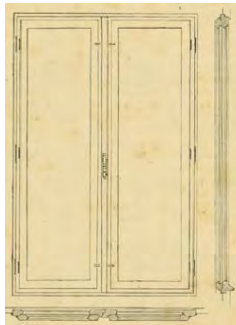
1 Details Doppelverglasung, Drehpunkte noch getrennt; in: Graef. Der praktische Fensterbauer. Seite 123
